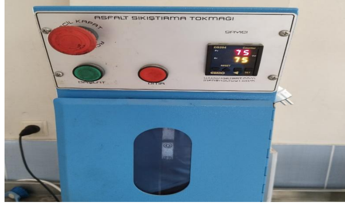
Şekil 19. Asfalt sıkıştırma tokmağıyla vuruş yapılması ve numunelerin sıkıştırılması
