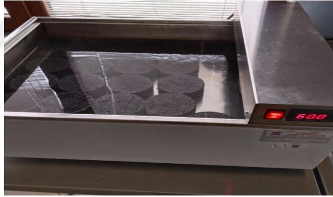
Şekil 21. 30 dakika 60 °C sıcaklıkta bekletilen numuneler
