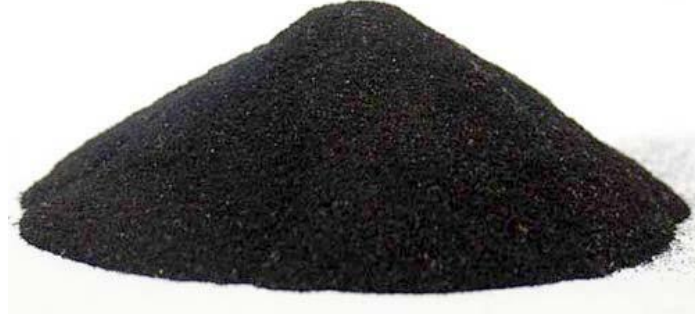
Şekil 6. Öğütülmüş kırıntı kauçuk görünümü (Tyre Recycling Solutions, 2022)
