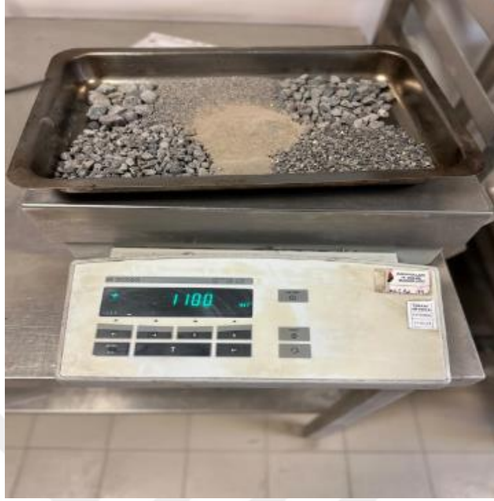
Şekil 32. Agregaların 1100 Gramlık Briketler İçin Hazırlanması
