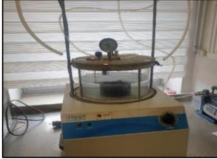
Şekil 47. Vakumlama ve Suda Bekletme
