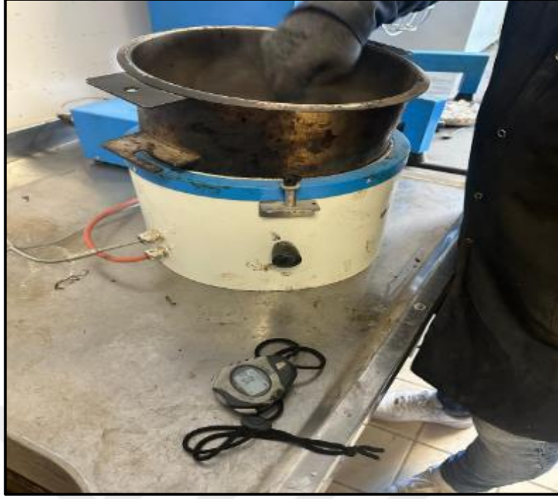
Şekil 38. Briket Hazırlığı İçin Karıştırma İşleminin Yapılması
