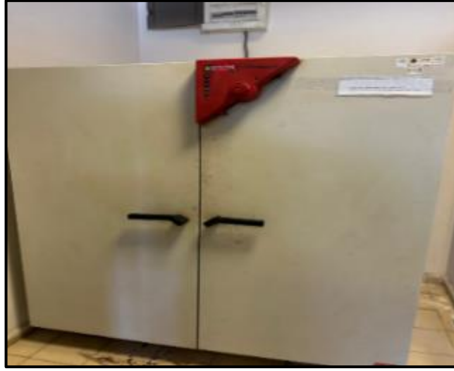
Şekil 34. Agregaların İstenen Sıcaklıklarda Etüvde Bekletilmesi
