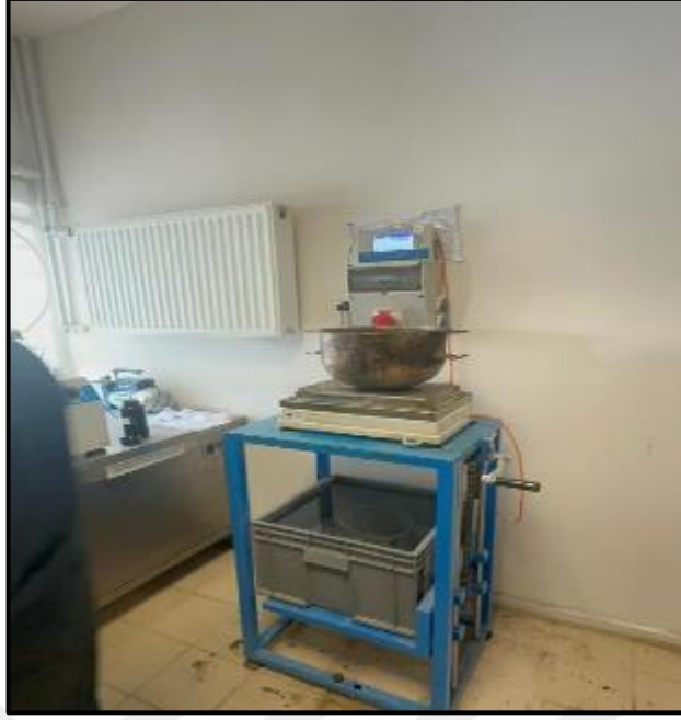
Şekil 36. Numunelerin Tartılarak Karıştırılacağı Düzenek
