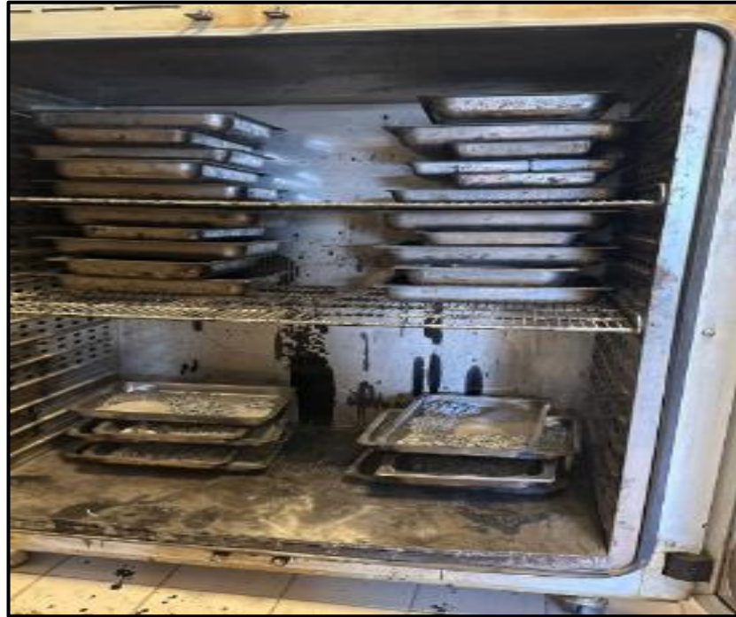
Şekil 33. Etüvde 24 Saat Kurumaya Bırakılan Numuneler
