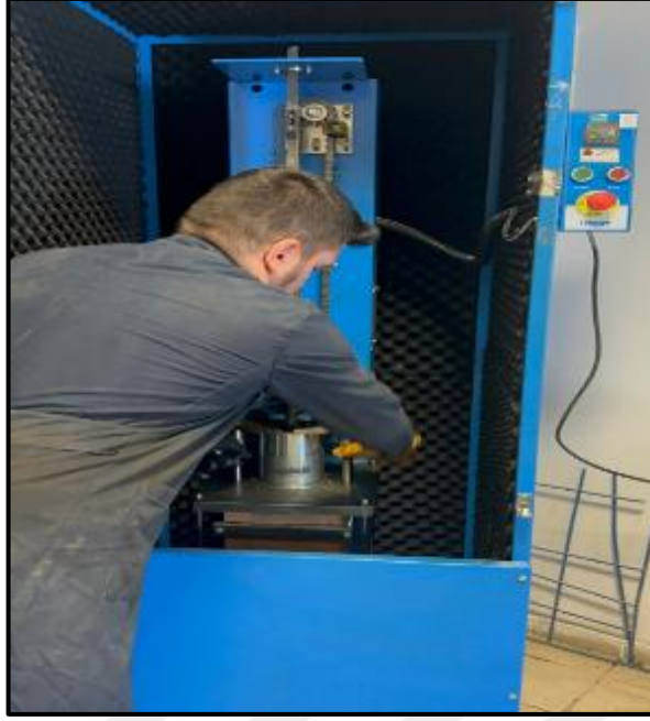
Şekil 42. Hazırlanan Kalıpların Sıkıştırma Makinesine Yerleştirilmesi
