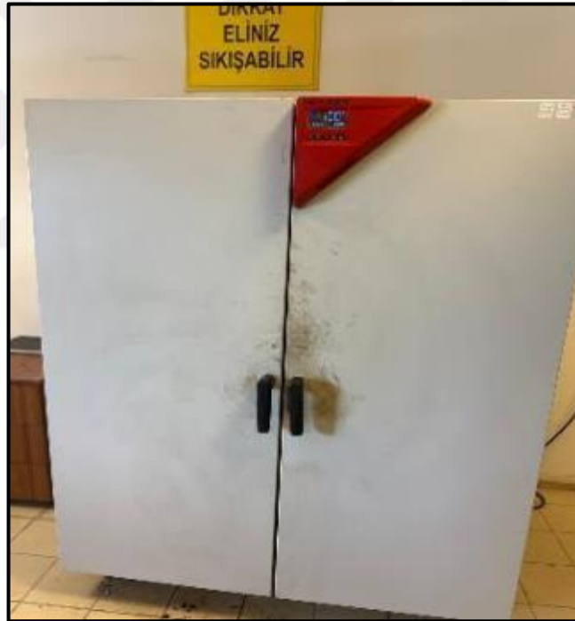
Şekil 35. Bitümün İstenen Sıcaklıklarda Etüvde Bekletilmesi
