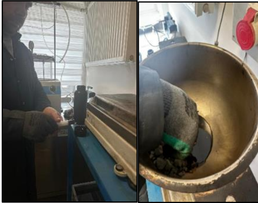
Şekil 37. Katkı Maddesinin Şırınga Yardımıyla Karışıma Eklenmesi
