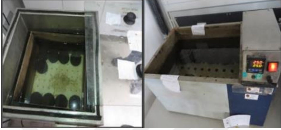
Şekil 49. Numunelerin 25^\circ\text{C} Su Banyosunda Bekletilmesi (KGM, 2012).
