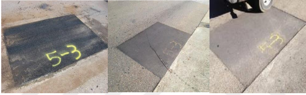
Şekil 16. Yarı Kalıcı Yama Örneğinin Zamanla Bozulma Performansı (Dong, Huang, & Jia, 2014).
