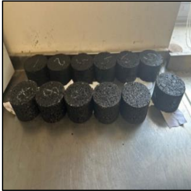
Şekil 45. Numaralandırılan ve 24 saat sonunda Kalıptan Çıkartılan Briketler
