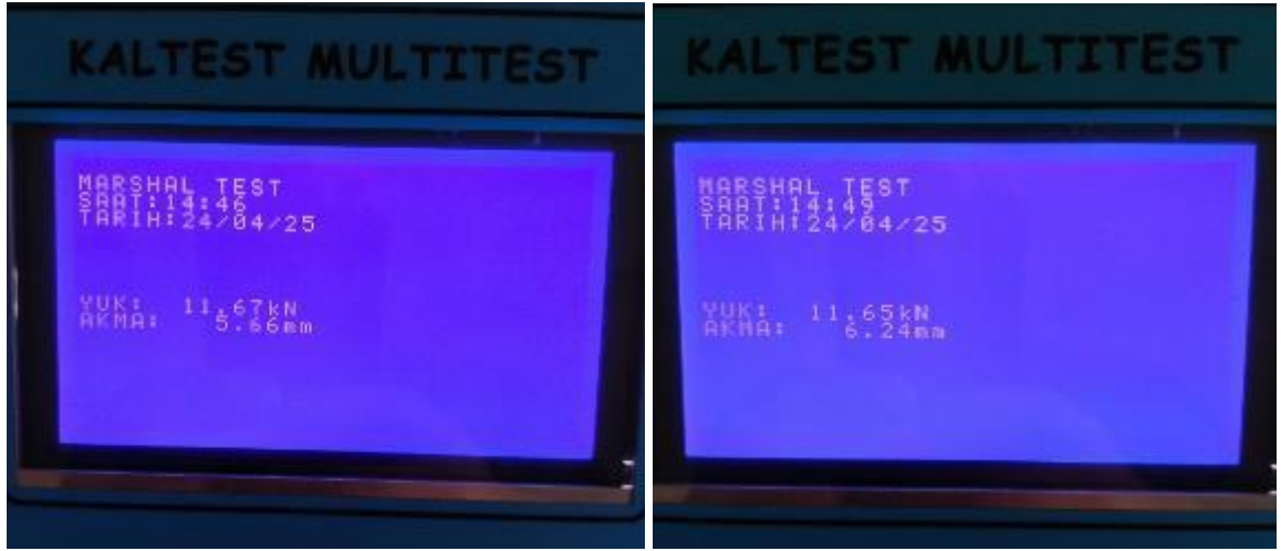
Şekil 37. Üretilen briketlerin (%5,2 bitümlü, %10 ve %15 ADK'li-48 saat ve 60°C su küründe) stabilite akma dayanımlarının tespiti
