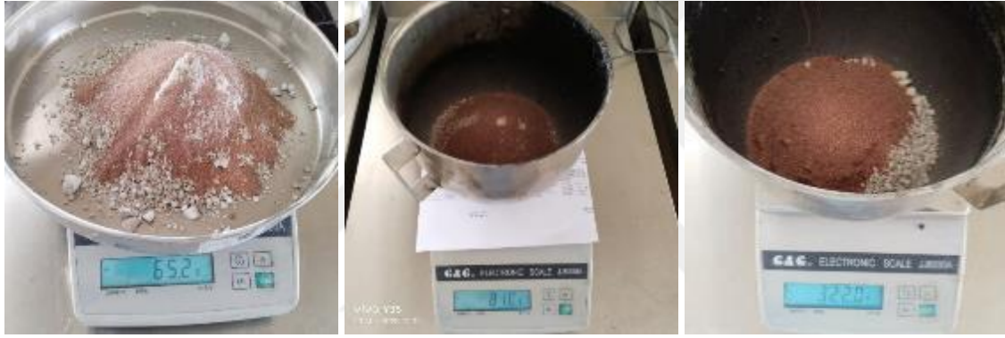
Şekil 8. Briketlerde kullanılacak %20, %25 ve %50 ADK oranının belirlenmesi
