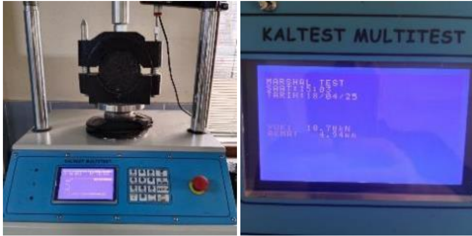
Şekil 33. Üretilen briketlerin (katkısız, %5,2 bitümlü-30 dakika ve 60°C su küründe) stabilite akma dayanım tespiti
