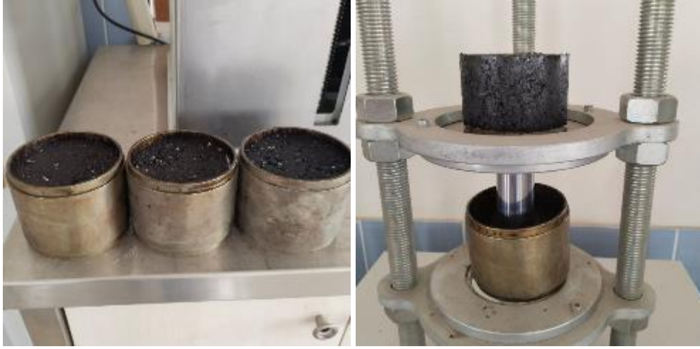
Şekil 13. Briketlerin 24 saat süreyle kalıpta bekletilip kriko yardımıyla kalıptan çıkarılması
