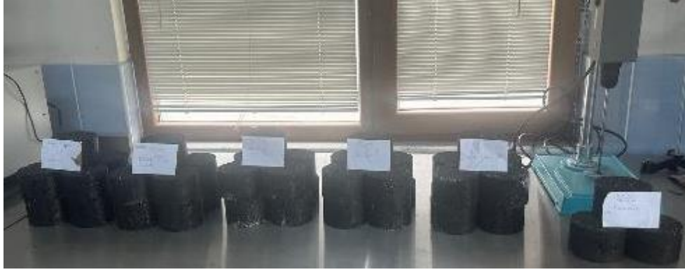
Şekil 14. Katkısız ve her bir ADK karışım (%10-15-20-25-50) için üretilen briketler
