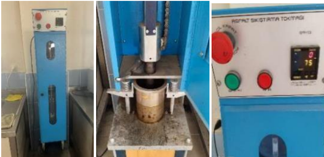
Şekil 12. Briket üretimi için kalıplara dökülen karışımın Marshall cihazında 75 kez tokmaklanması
