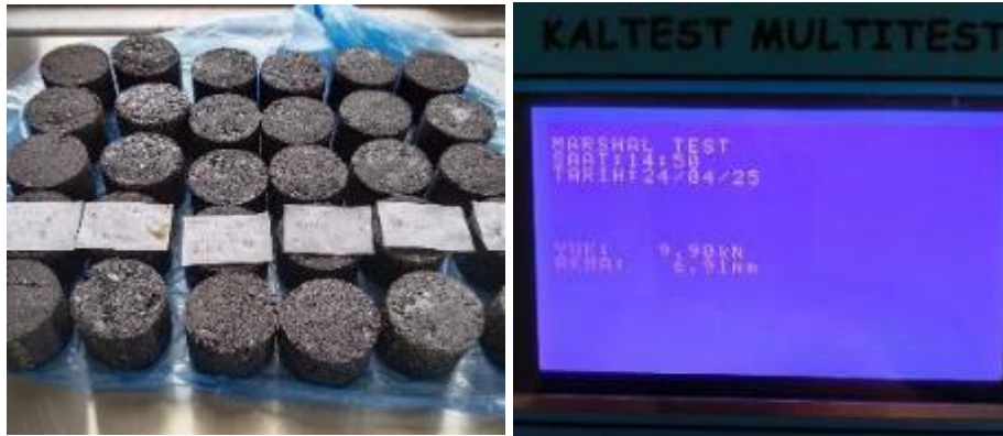
Şekil 36. Üretilen briketler ve katkısız %5,2 bitümlü 48 saat ve 60°C su küründe stabilite akma dayanımlarının tespiti
