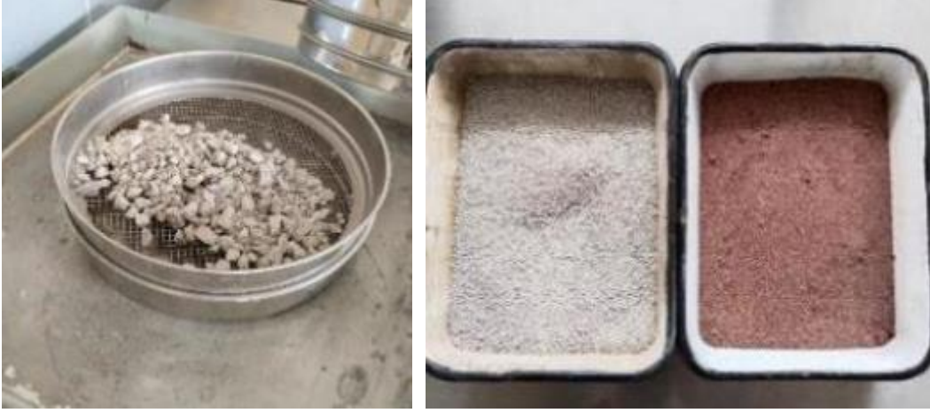
Şekil 4. Kalker agregası gradasyonu ve döküm kumuna denk kumun gradasyonunun belirlenmesi
