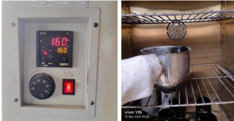
Şekil 9. Karışımın etüvde ısıtılarak hazırlanması
