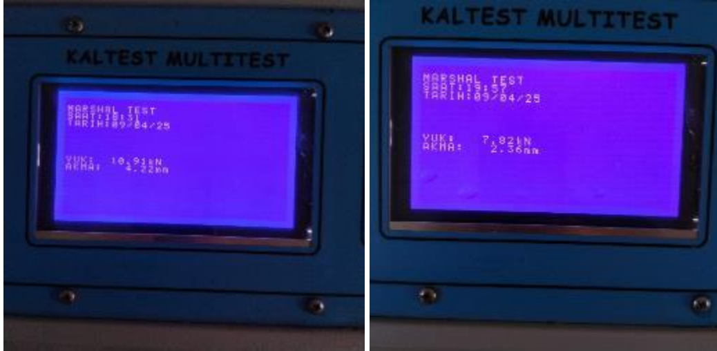
Şekil 22. Üretilen briketlerin (%25 ve %50 ADK'li numune) stabilite akma dayanımlarının tespiti
