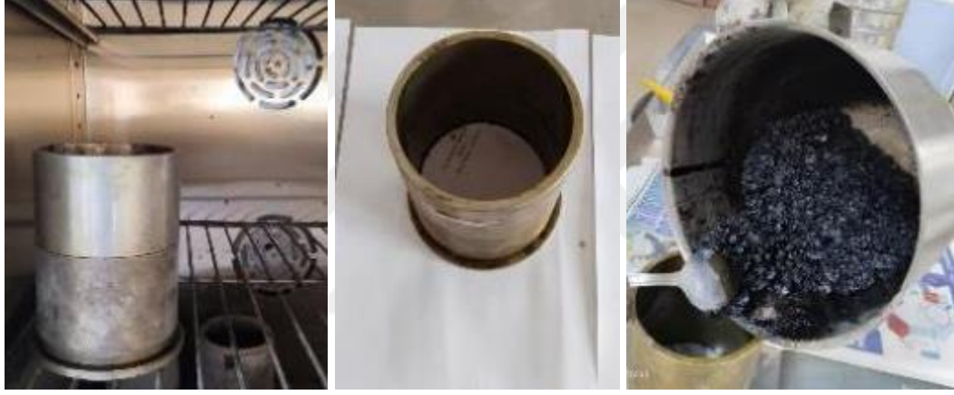
Şekil 11. Kalıpların aynı sıcaklıkta ısıtılıp yağlanması ve karışımın kalıplara dökülmesi
