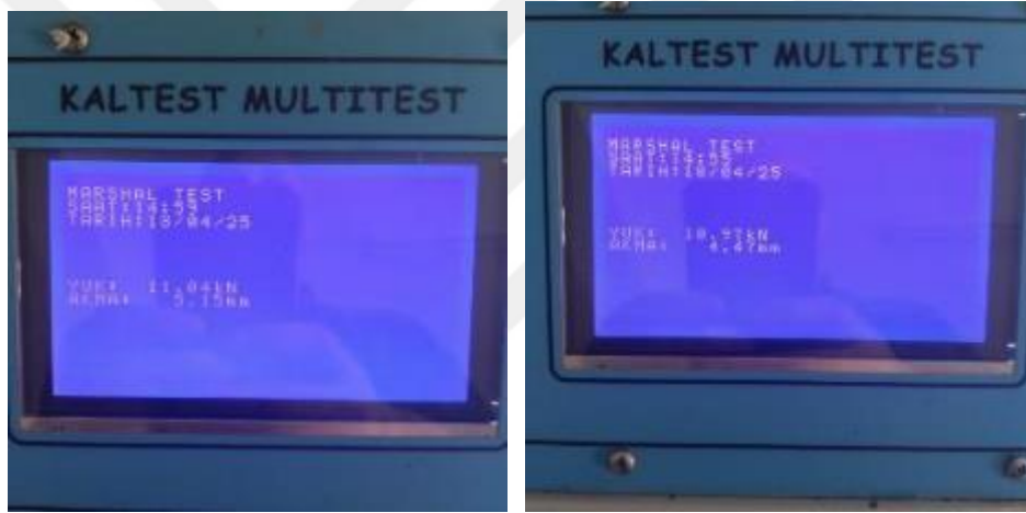
Şekil 35. Üretilen briketlerin (%5,2 bitümlü, %20 ve %25 ADK'li-30 dakika ve 60°C su küründe) stabilite akma dayanımlarının tespiti
