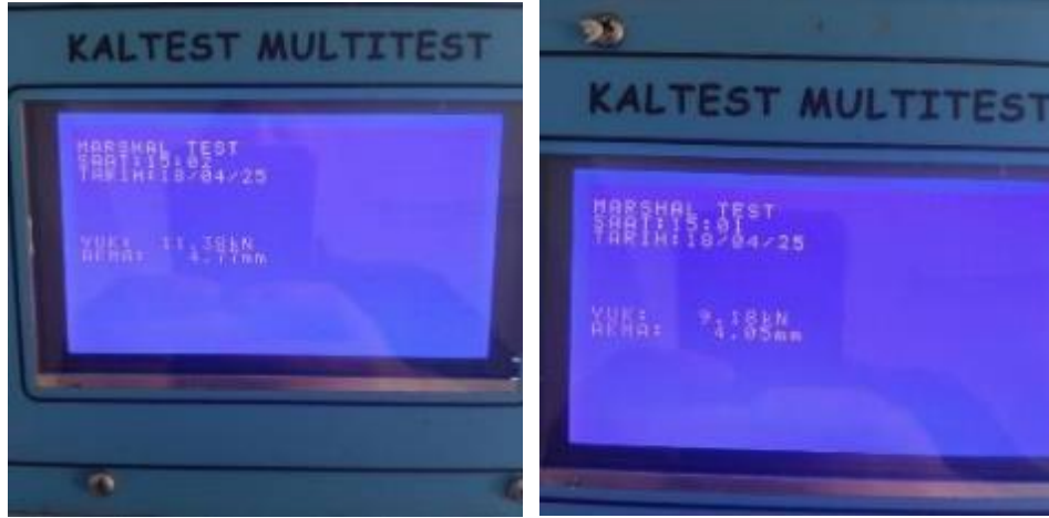
Şekil 34. Üretilen briketlerin (%5,2 bitümlü, %10 ve %15 ADK'li-30 dakika ve 60°C su küründe) stabilite akma dayanımlarının tespiti
