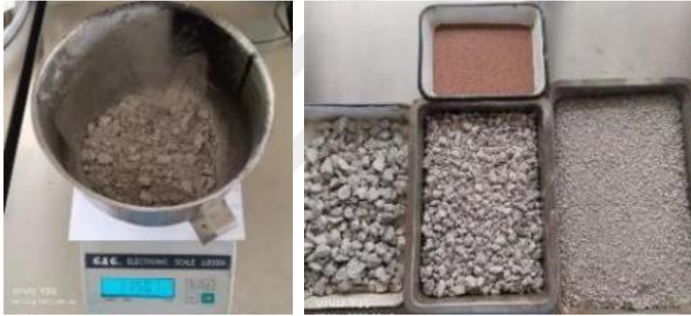
Şekil 5. Briketlerde kullanılacak kalker agregası ve agrega grupları
