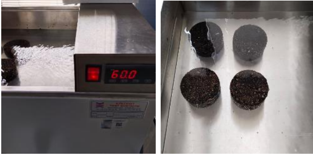
Şekil 18. Üretilen briketlerin 30 dakika, 60°C su kürüne tabi tutulması
