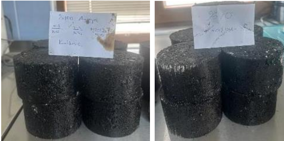
Şekil 15. Standart üretim ve %10 ADK karışım briketler
