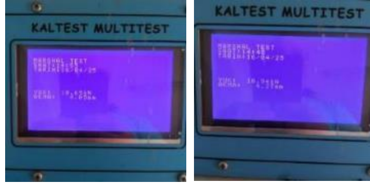
Şekil 24. Üretilen briketlerin (%15 ve %20 ADK'li numune-48 saat ve 60°C su küründe) stabilite akma dayanımlarının tespiti
