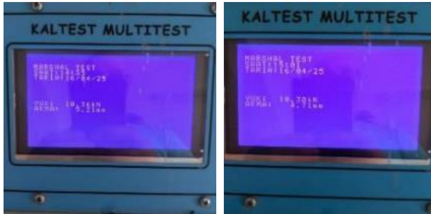
Şekil 23. Üretilen briketlerin (katkısız ve %10 ADK'li numune-48 saat ve 60°C su küründe) stabilite akma dayanımlarının tespiti
