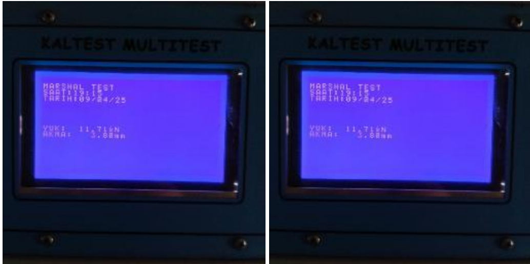
Şekil 21. Üretilen briketlerin (%15 ve %20 ADK’li numune) stabilite akma dayanımlarının tespiti
