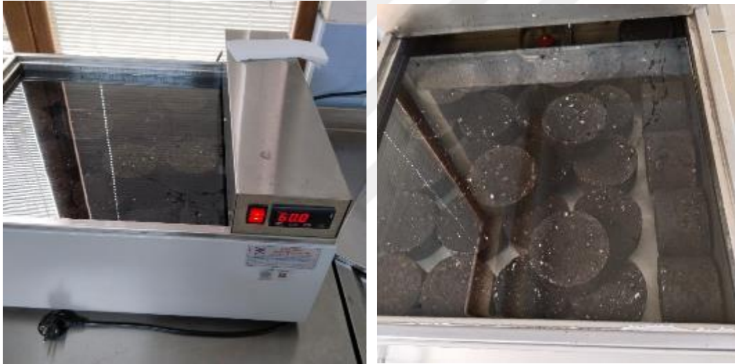
Şekil 19. Üretilen briketlerin 48 saat, 60°C su kürüne tabi tutulması
