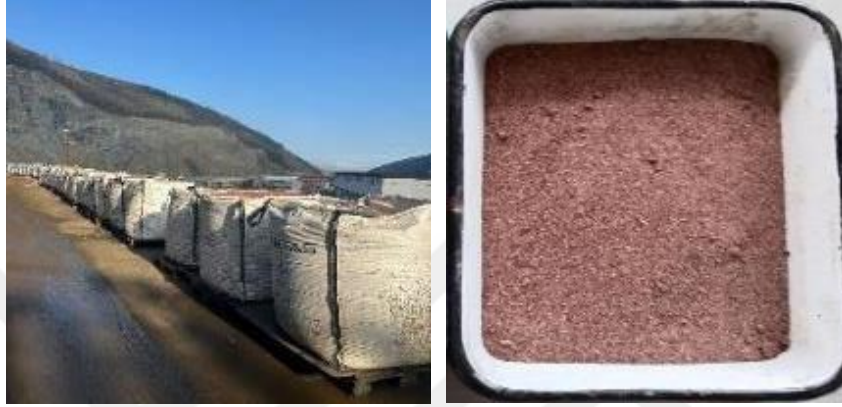
Şekil 1. Şantiyede depolanan atık döküm kumu ve laboratuvar atık döküm kumu
