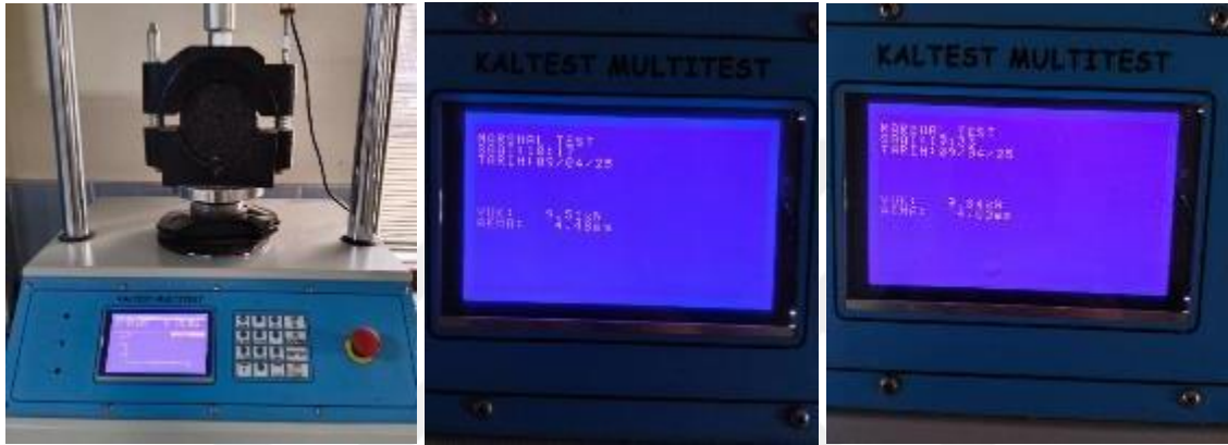
Şekil 20. Üretilen briketlerin (katkısız ve %10 ADK’li numune) Kaltest cihazıyla stabilite akma dayanımlarının tespiti
