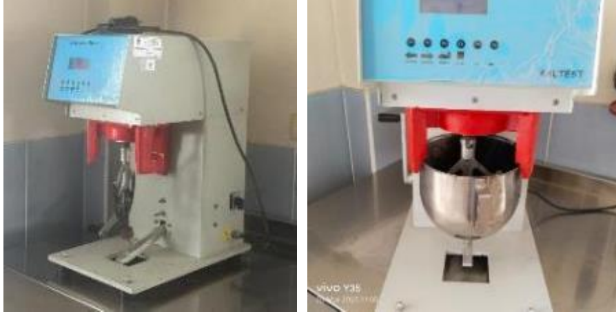
Şekil 10. Etüvde ısıtılan sıcak karışımların mikser karışım cihazında karıştırılması
