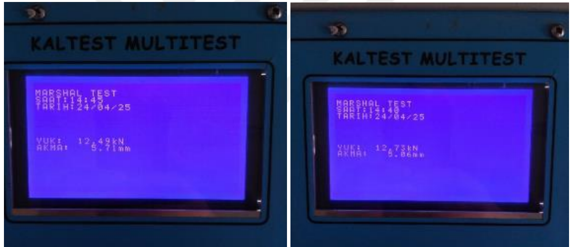
Şekil 38. Üretilen briketlerin (%5,2 bitümlü, %20 ve %25 ADK'lu 48 saat ve 60°C su küründe) stabilite akma dayanımlarının tespiti
