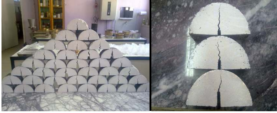
Şekil 7.92. Deney numunelerinin bir kısmı ve değişik yükseklikte çentiğe sahip numuneler
