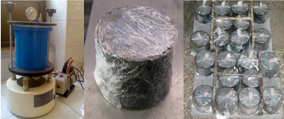
Şekil 6.2. Piknometre ve vakum cihazı, numunelerin koşullandırma işlemi için hazırlanması
