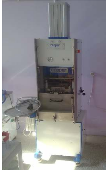
Şekil 7.8. Cooper yoğurmalı sıkıştırıcı
