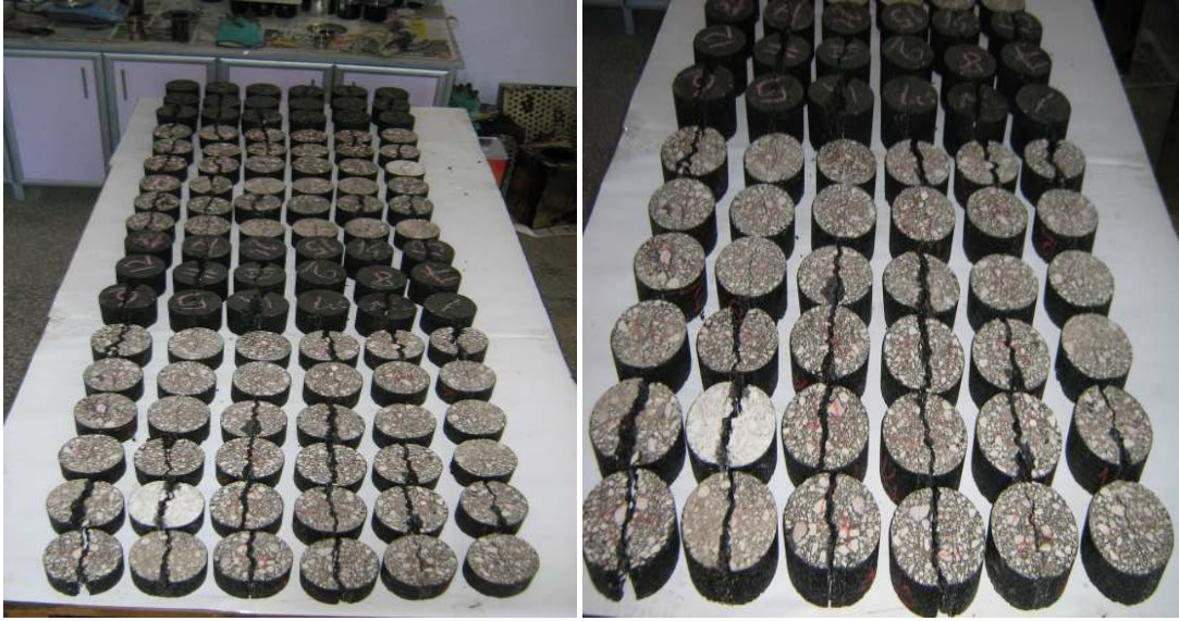
Şekil 7.40. Yorulma deneyi sonrasında numunelerin görünüşü
