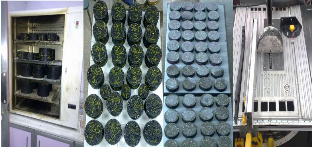
Şekil 7.91. Numunelerin uzun dönem yaşlandırılması ve kesilmesi
