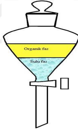
Şekil 2.2. Solvent ekstraksiyonda faz ayırma balonunun şematik gösterimi.
