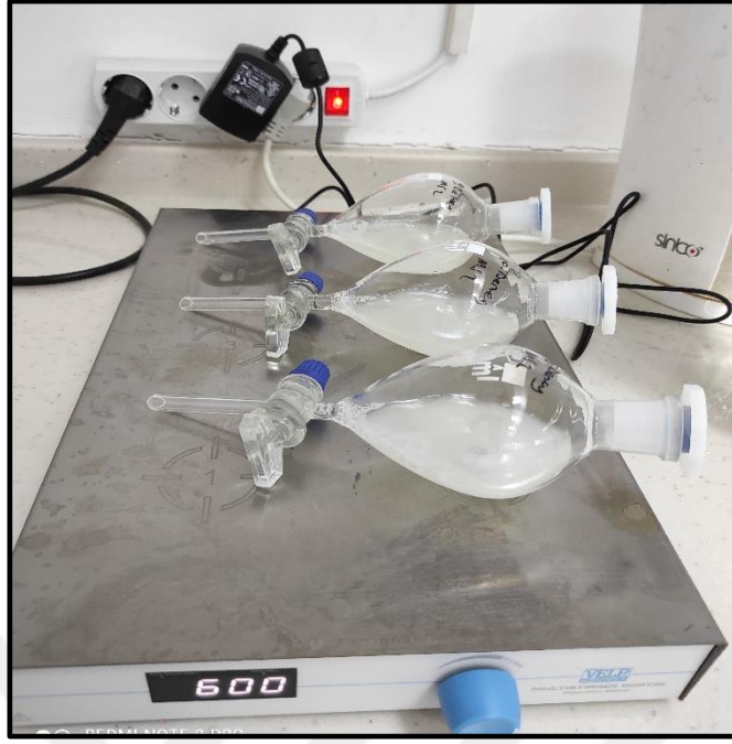
Şekil 3.2. Solvent ekstraksiyon için karıştırma düzeneği.
