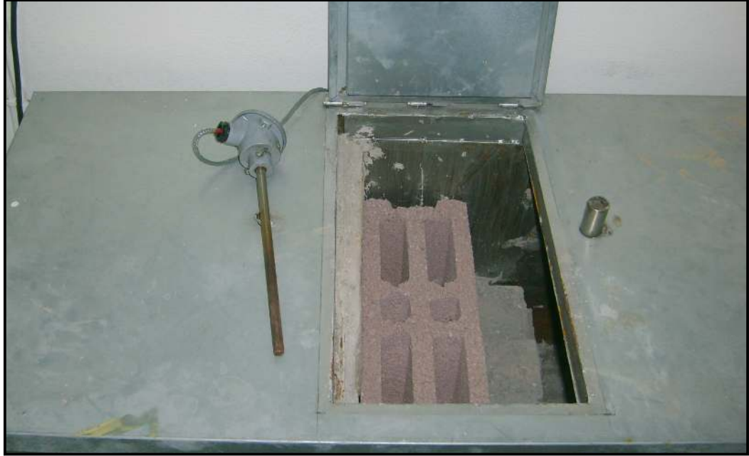
Şekil 4.7. Bimsblok konulmuş 2.hazne ve termometre ucunun genel görünümü
