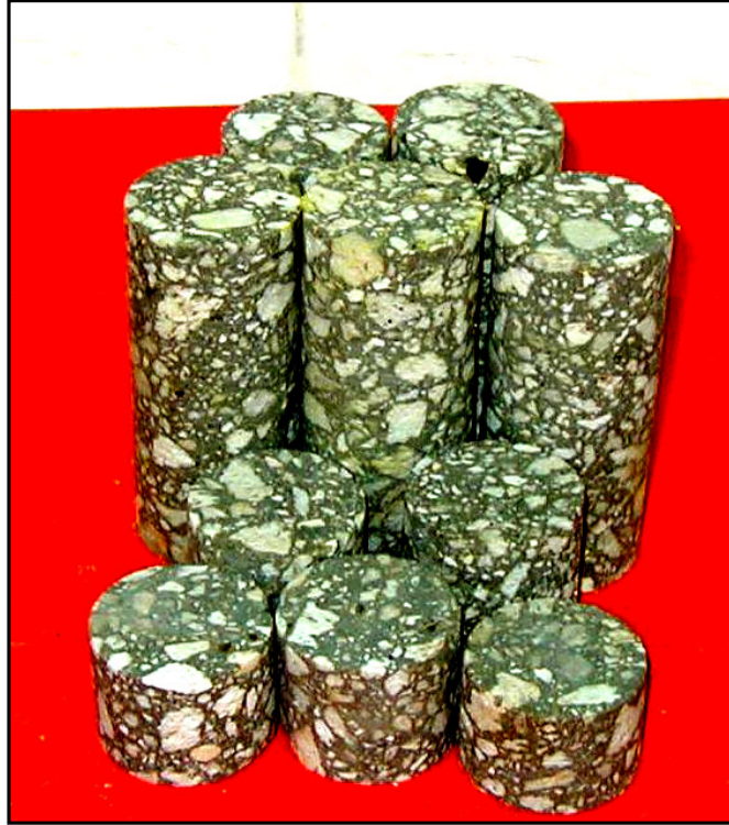
Şekil 5.34. Nevşehir asidik pomza betonlarından alınan karot numuneleri
