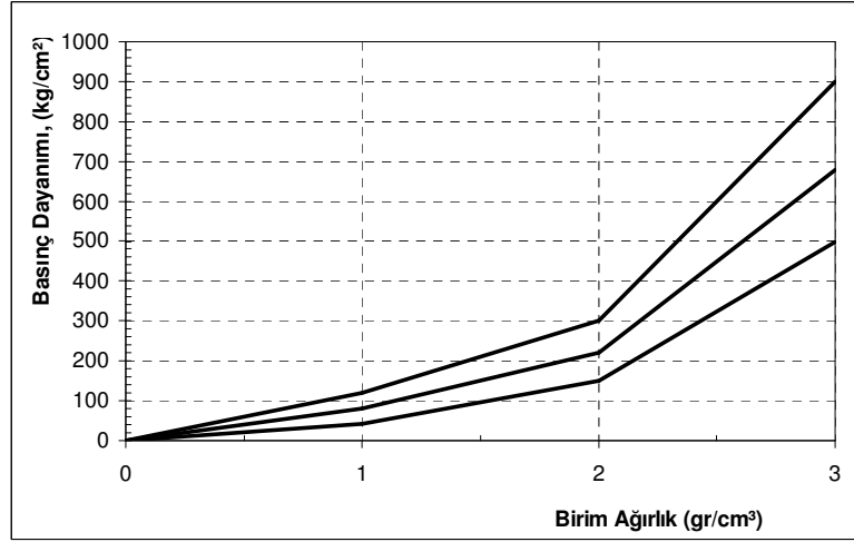
Şekil 2.5. Taş türü malzemeler için \sigma_{\max} -dh arasındaki ilişki (Gündüz vd, 1998a)
