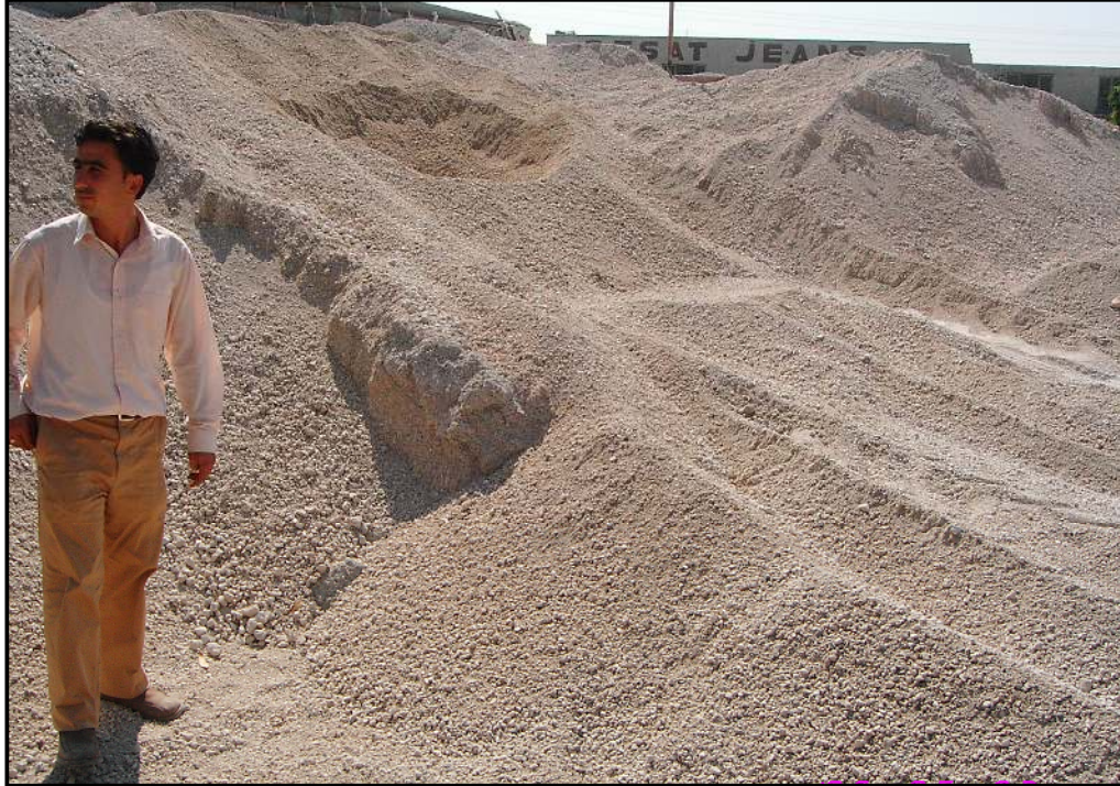
Şekil 4.14. Deneylerde kullanılan Nevşehir asidik pomza hammaddesi
