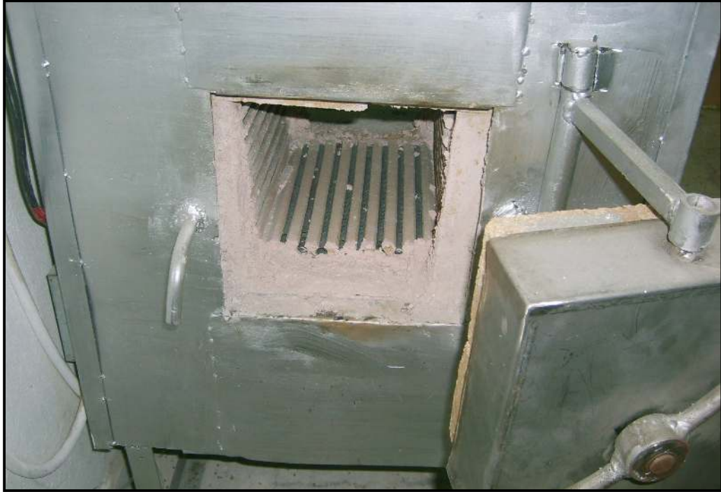
Şekil 4.6. Isıyı üreten 1. haznenin görünümü
