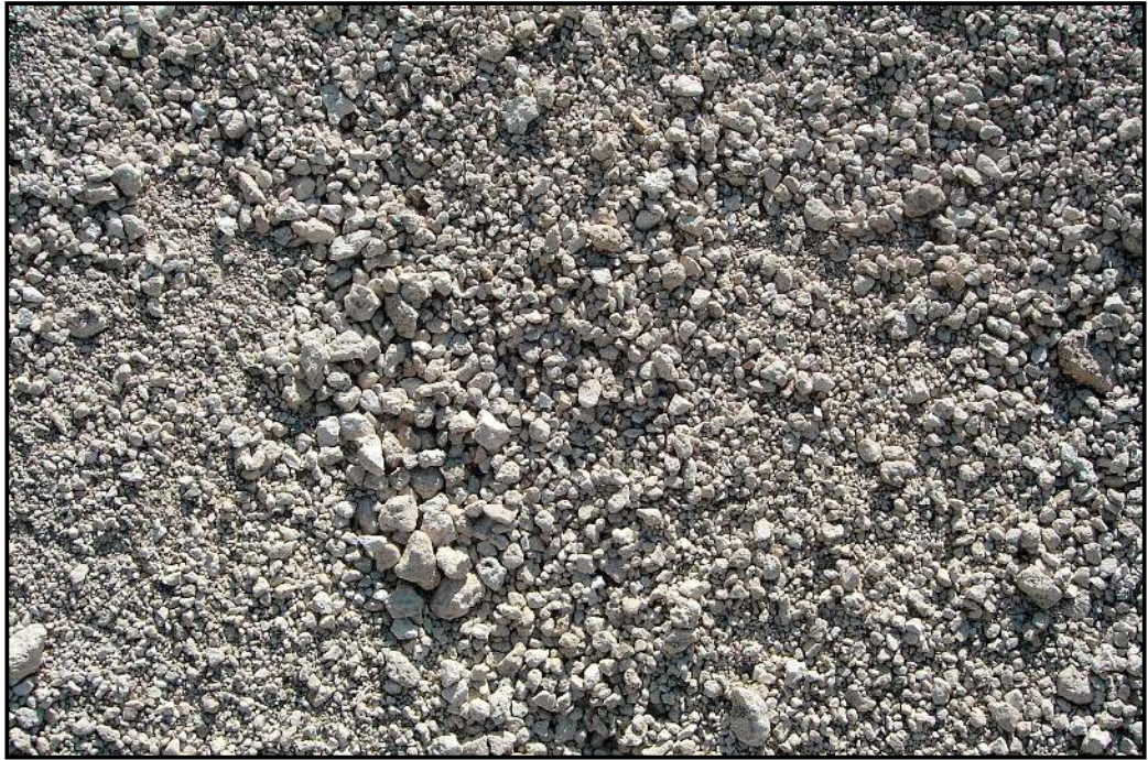
Şekil 5.3. Kırılıp elemeye tabi kalmış Nevşehir asidik pomza yığın numuneleri
