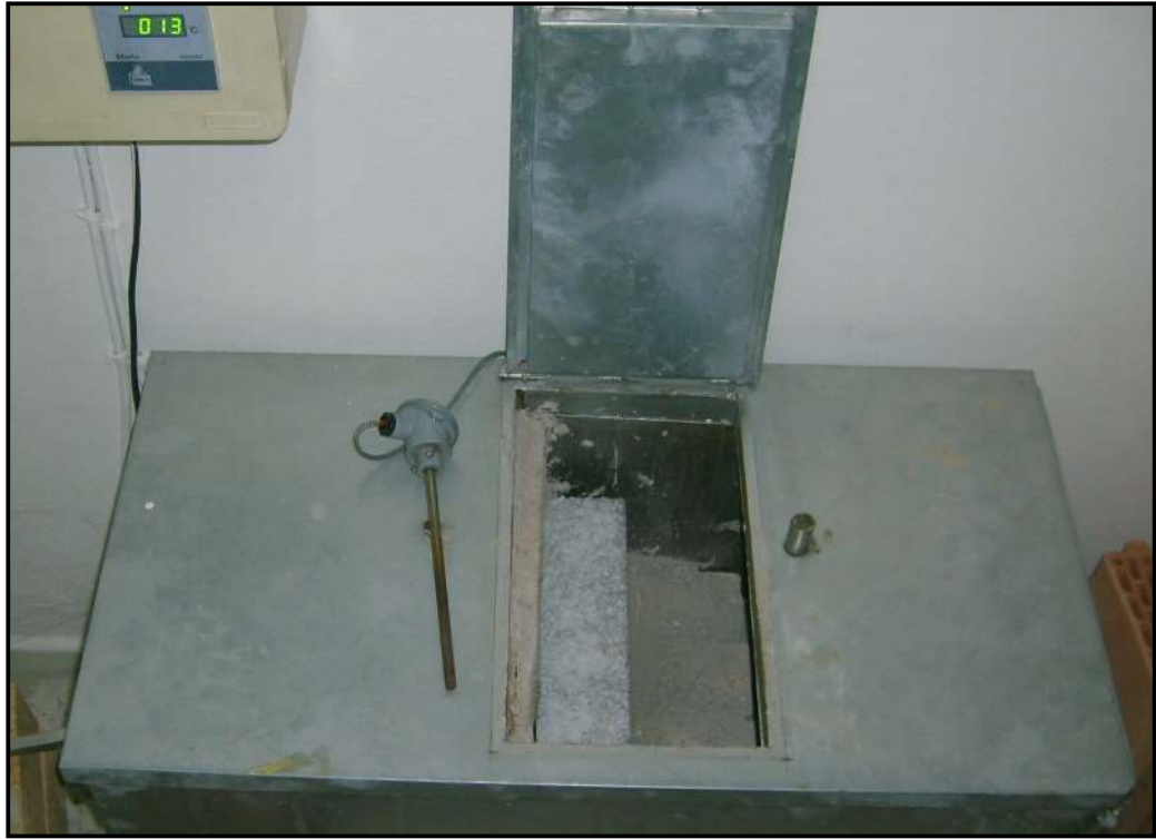
Şekil 4.8. Beton kalıpdaki ısı iletim katsayısının ölçümü ve etüvün genel görünüşü
