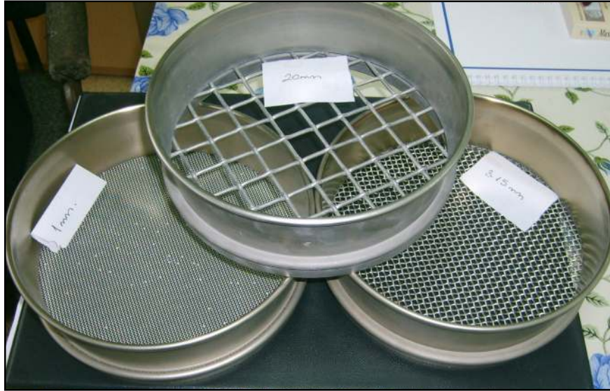
Şekil 3.4. Kare göz açıklıklı elekler (0.25 mm ile 31.5 mm arası)
