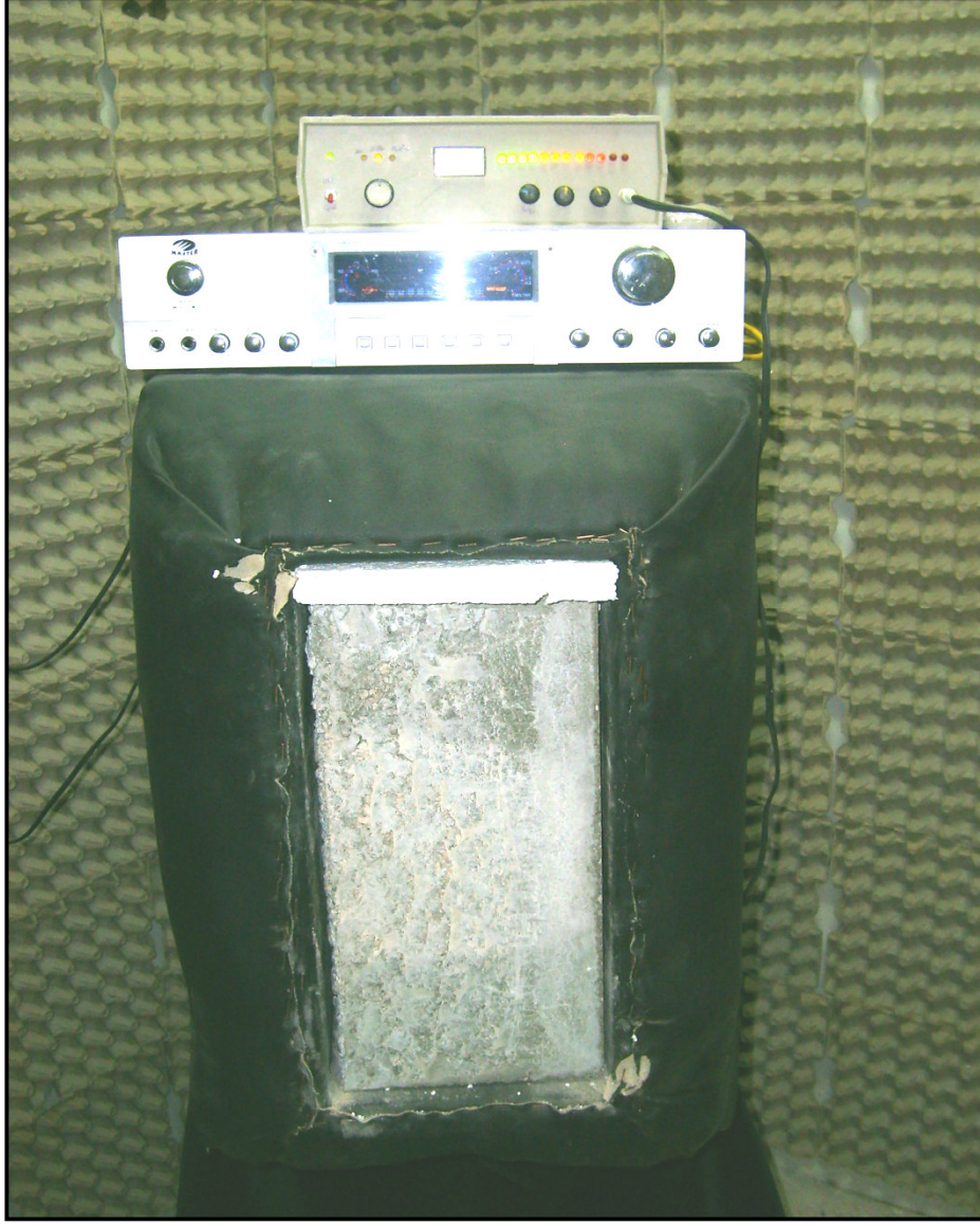
Şekil 4.13. Beton blok konulduktan sonra yapılan ses ölçümleri
