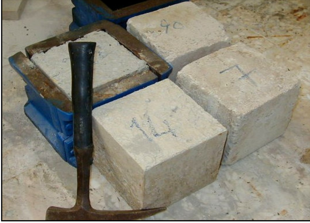
Şekil 5.33. Hafif beton örneklerinin blok kalıplara dökülmüş hali
