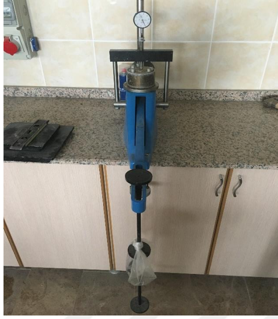
Şekil 4.26. Şişme yüzdesi deneyinden bir görünüm
