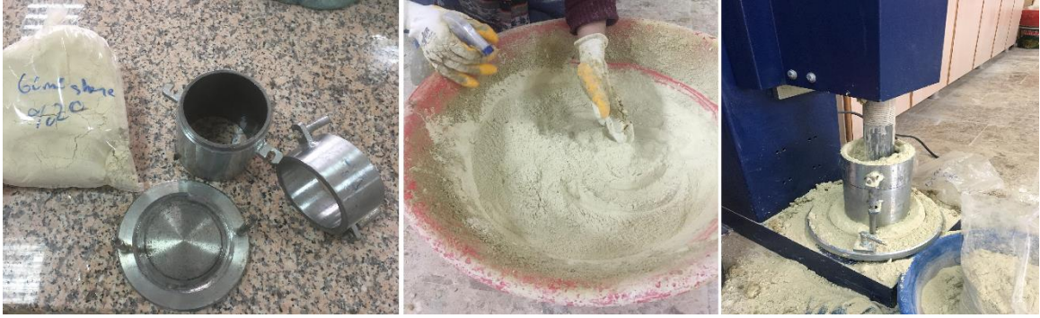
Şekil 4.6. Zemin örneğinin hazırlanması ve sıkıştırılması
