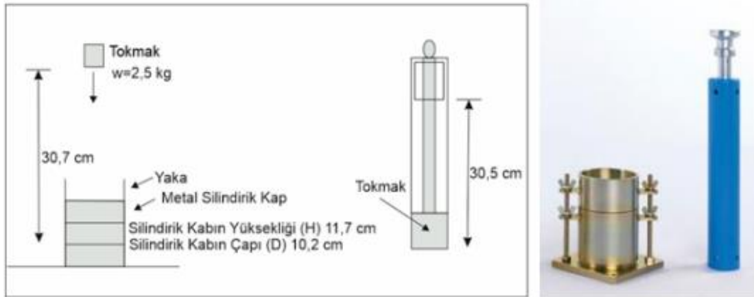
Şekil 4.5. Standart Proktor deney aletinin görünümü (Aslan Topçuoğlu, 2020)
