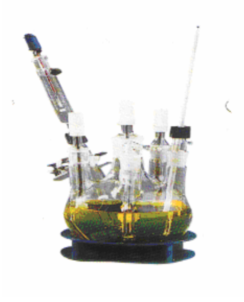
Resim 3.2. Korozyon hücresinin fotoğrafı.
