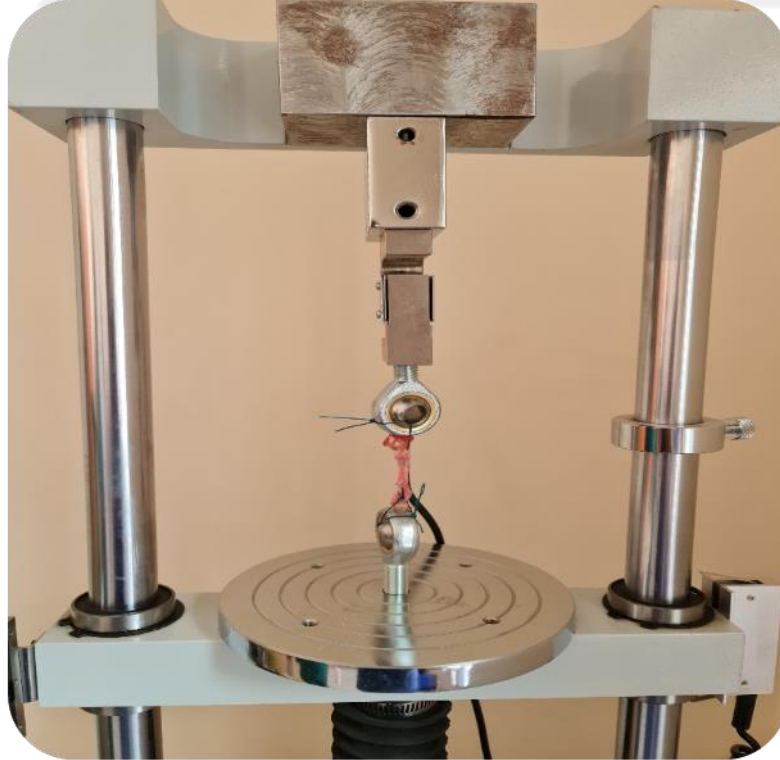
Şekil 44. Test anında olan ve çekme testinde kopmak üzere olan tendonun görünümü
