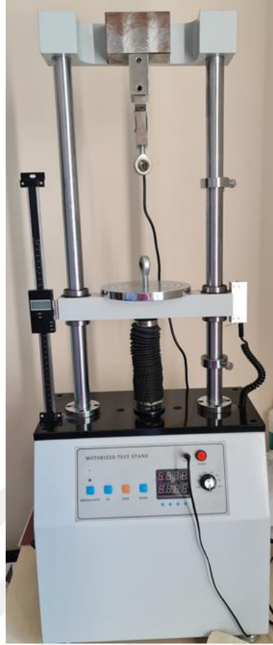
Şekil 41. Geratech SH-5000 biyomekanik test cihazında testler gerçekleştirildi
