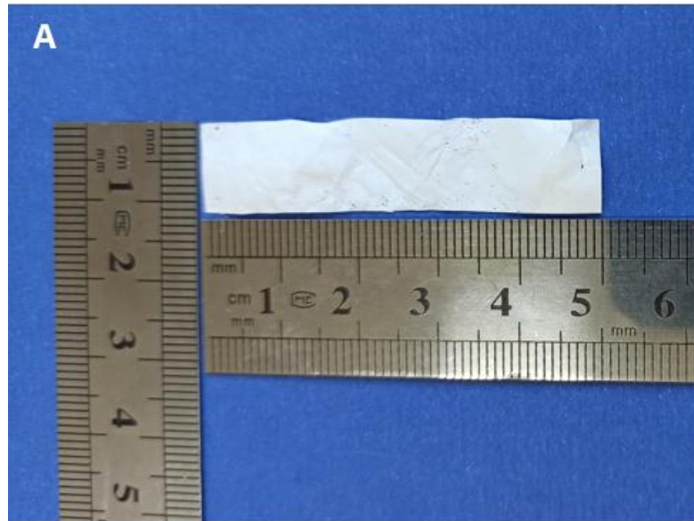
Şekil 23. 5 cm boyunda 1 cm eninde üretilmiş olan PLGA nanofiber makro görüntüsü
