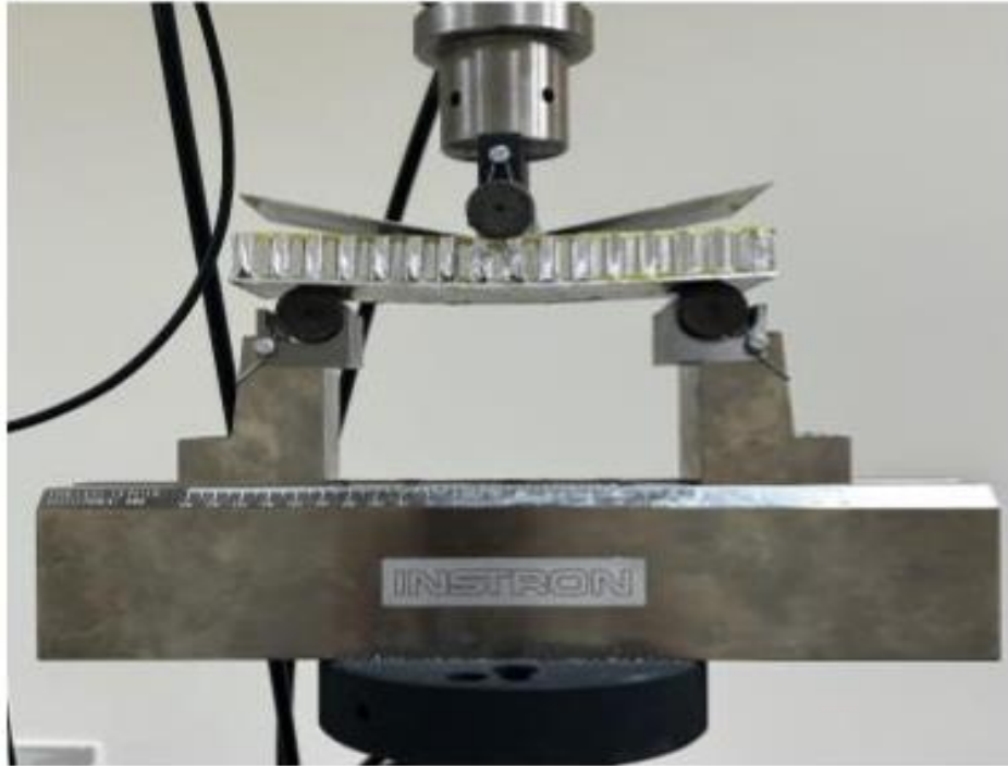
Şekil 30. Epoksi yapıştırıcı kullanılarak üretilmiş bir kompozit sandviç panelin deformasyon davranışı
