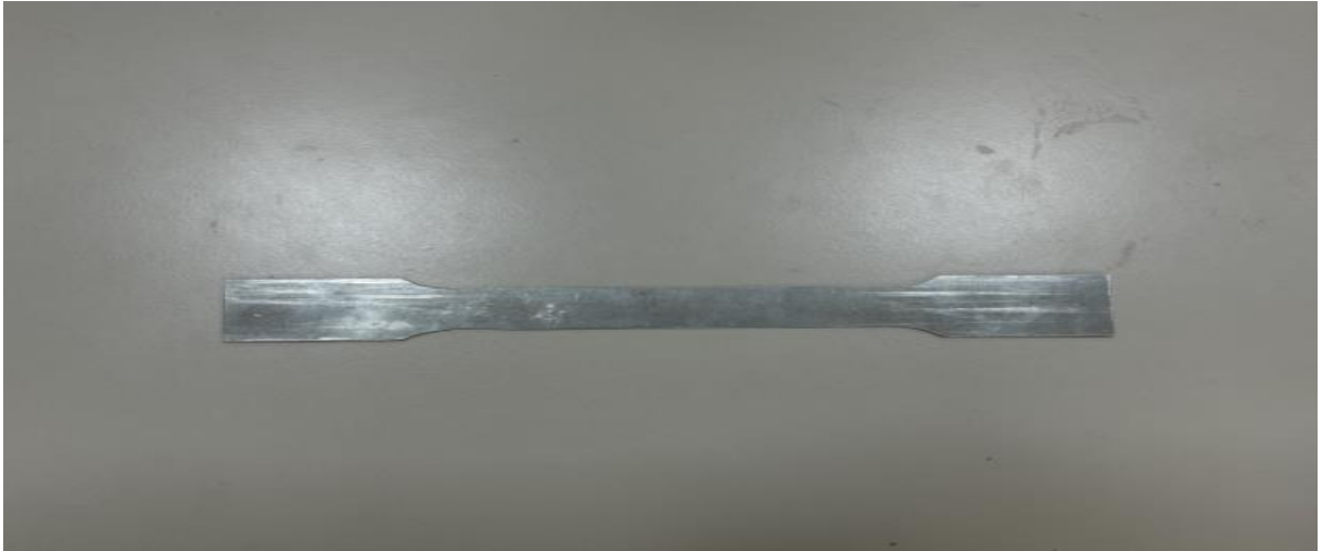
Şekil 17. ISO 6892 standardına göre hazırlanan örnek çekme numunesi
