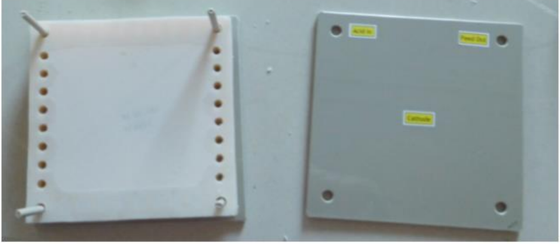
Şekil 3.13. Membran ve spacerların ED sistemlerine yerleştirilme şekli
