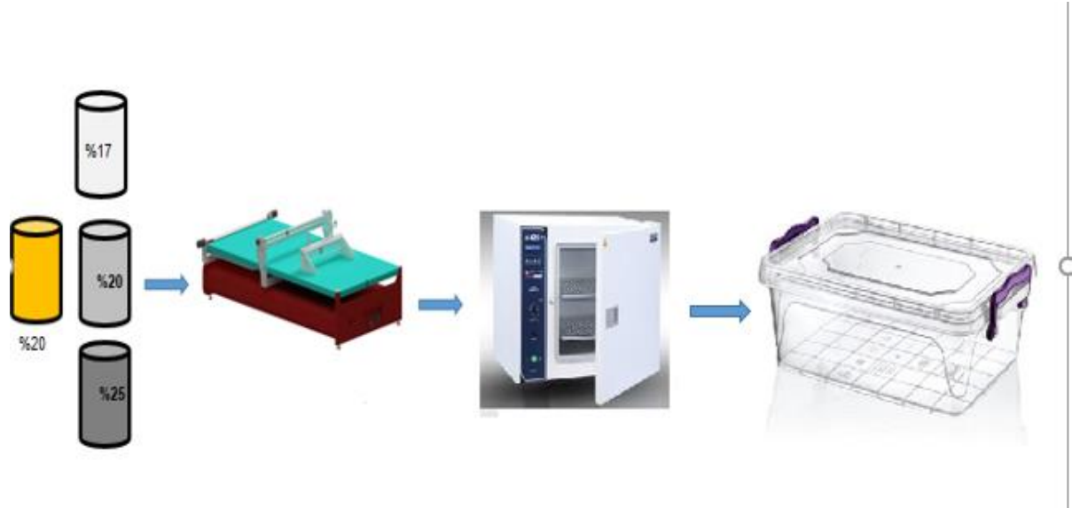
Şekil 3.5. Çözücüsü dimetilformamid olan bipolar membranların döküm ve oluşum şeması
