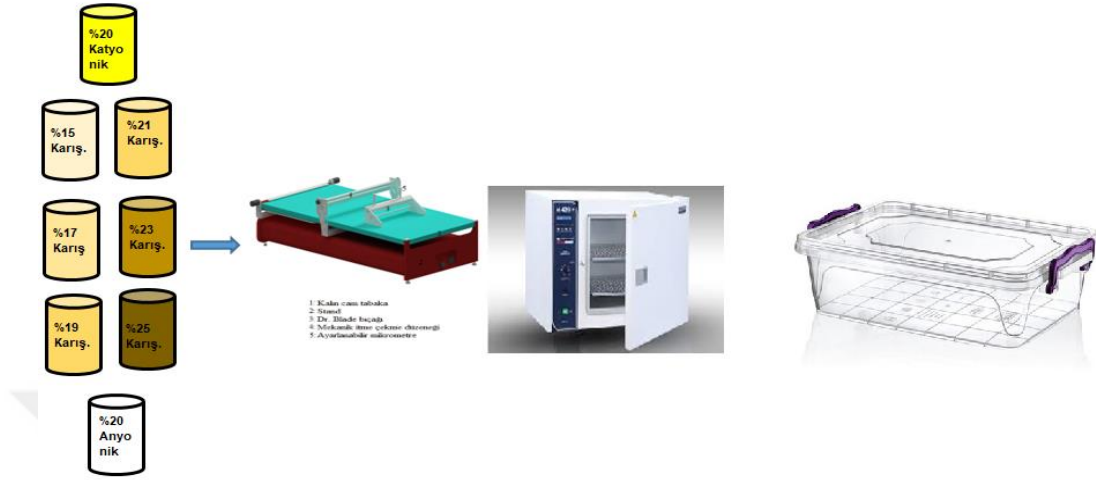
Şekil 3.4. Çözücüsü kloroform olan ve ara tabakası karışım polimeri olan bipolar membranların döküm ve oluşum şeması
