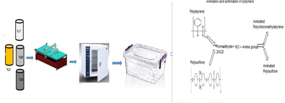
Şekil 3.6. Çözücüsü dimetilformamid olan ve polistrinden üretilen PKMS'li bipolar membranların döküm ve oluşum şeması
