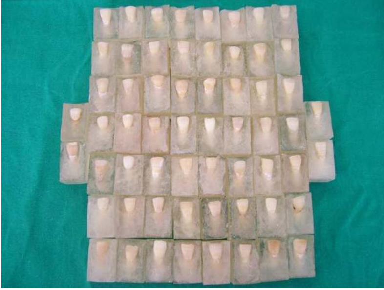
Resim 1: Akrilik bloklara gömülmüş ve herhangi bir işlem uygulanmamış olan 60 adet diş.
