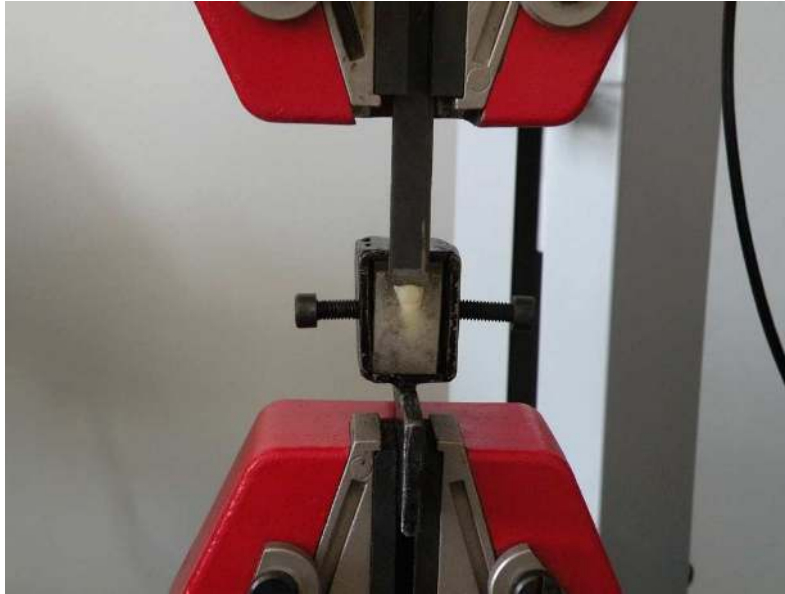
Resim 12: Hazırlamış olduğumuz örneklerle Shear testi uygulanması.
