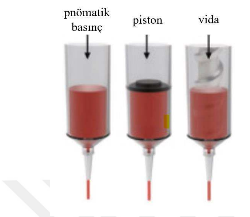
Şekil 2.6. EBB’de pnömatik, mekanik pistonlu ve mekanik vidalı tabanlı sistem baskısı [33]
