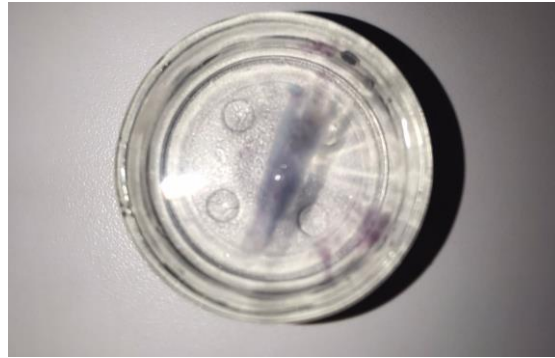
Şekil 4.2. İçi boş damar benzeri yapı iskelesinin jelatin destek banyosundan çıkarıldıktan sonraki görüntüsü
