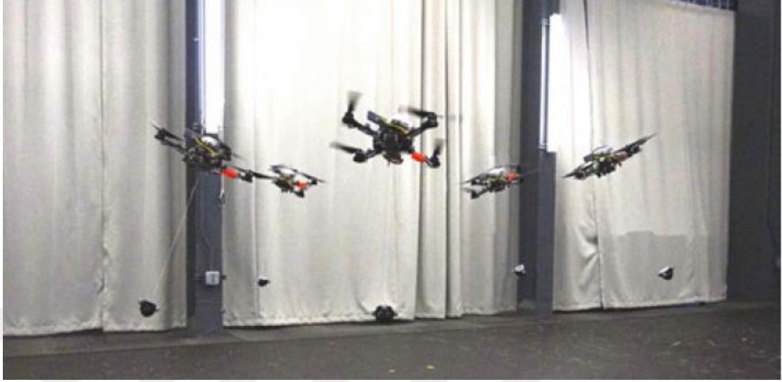
Şekil 2.1. Yük taşırken agresif manevra yapan quadrotor (Tang et al. 2018)
