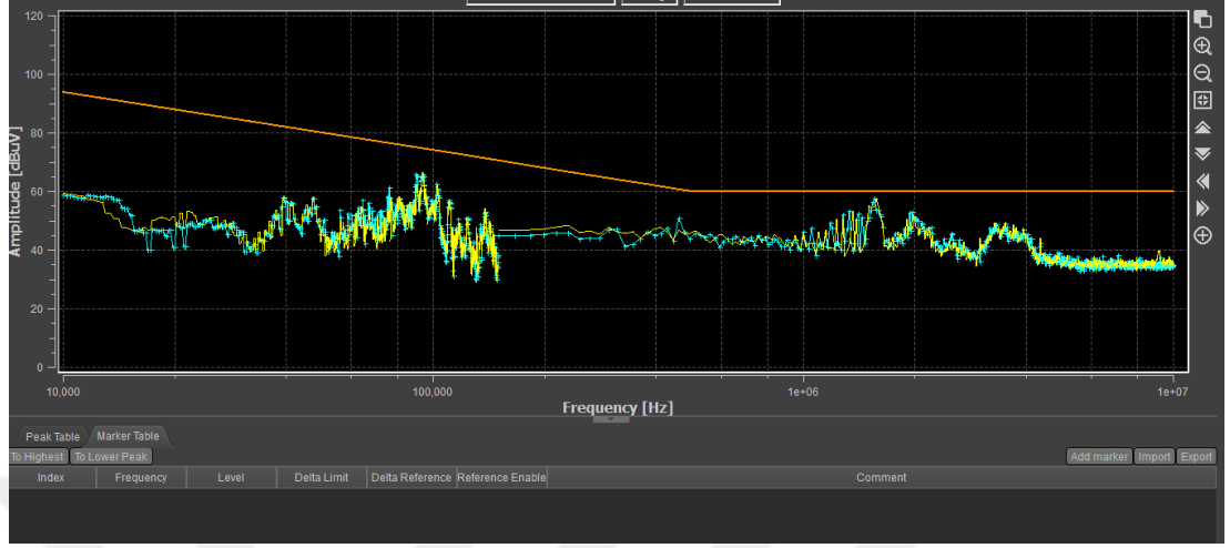
Şekil 3.55. Girişe 3.3 \mu\text{F} kapasitör ve 130 mH CMC eklenmiş ölçüm sonucu.
