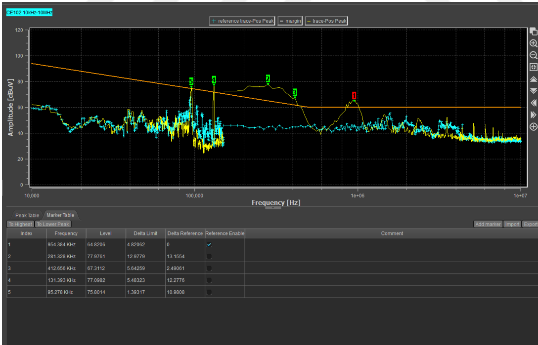
Şekil 3.44. 28 V DA + hattan alınan ölçüm (iki server aktif).
