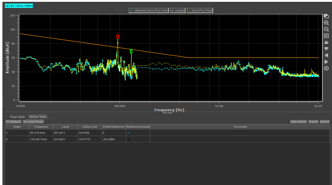
Şekil 3.52. Laird marka CMC devreden çıkarılıp 4.3 mH CMC eklenmiş durumdaki ölçüm sonucu.
