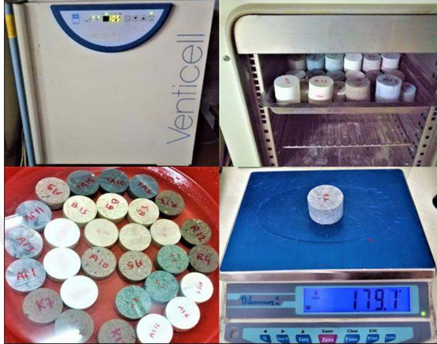
Şekil 2.10. Doğal taşların fiziksel özelliklerinin belirlenmesi
