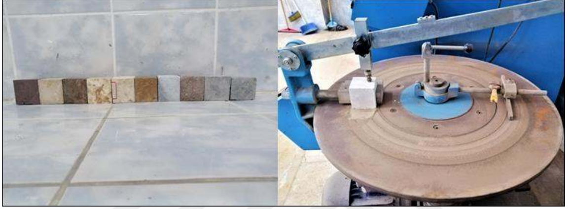
Şekil 2.7. Küp numuneler ve Böhme aşınma deneyi
