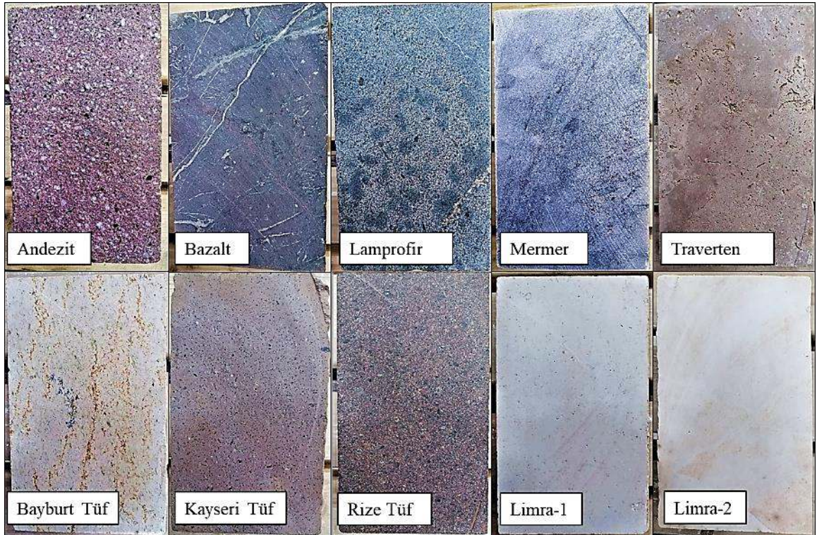
Şekil 2.15. ASJ ile kesilecek doğal taş plaka numunelerin yüzey görünümleri
