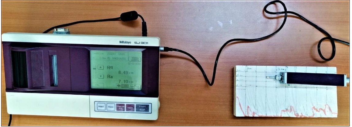
Şekil 2.25. Pürüzlülük cihazı ve kesim yüzeylerinde pürüzlülük ölçümü
