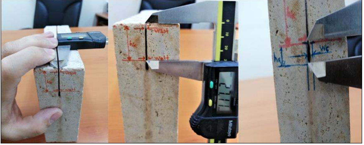
Şekil 2.21. Kesme genişliği, kerf açısı ve çakılma bölgesi verilerinin ölçümü
