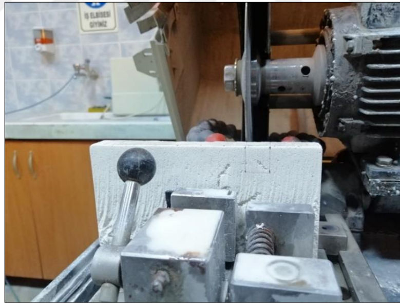
Şekil 2.27. SEM analizi için ASJ kesim yüzeylerinden örnek hazırlanması
