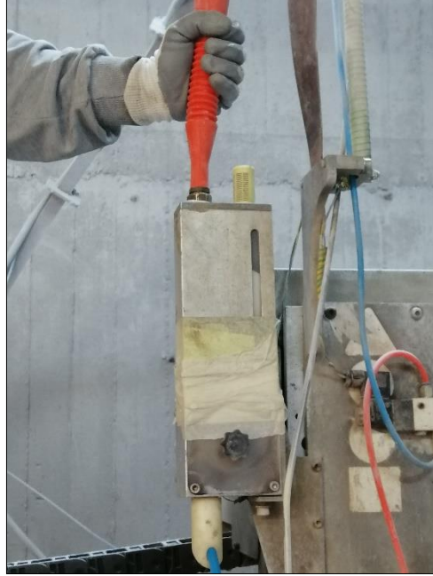
Şekil 2.18. Aşındırıcının hazneye beslenmesi
