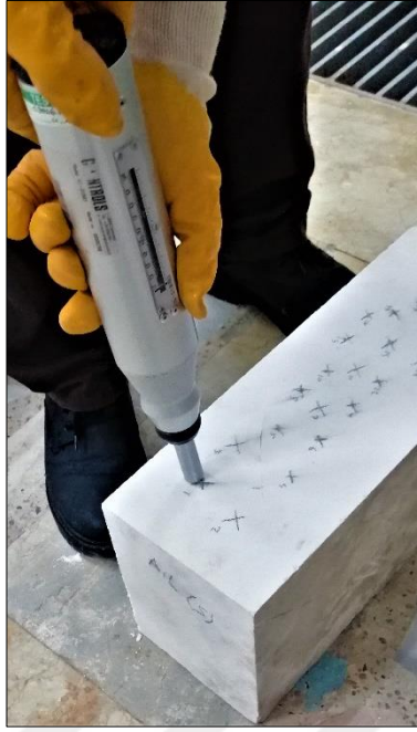
Şekil 2.6. Schmidt çekici ile sertlik tayini
