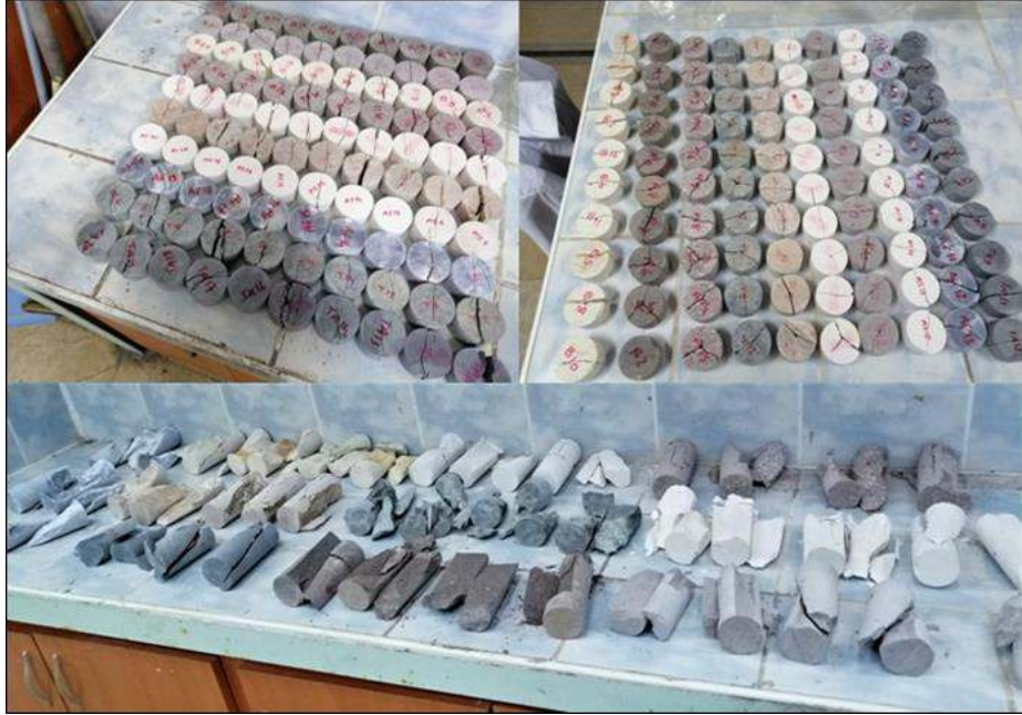
Şekil 2.12. Dayanım deneyleri sonrası kırılmış numuneler
