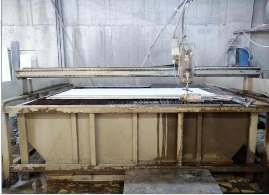
Şekil 2.16. Çalışmada kullanılan ASJ deney düzeneği
