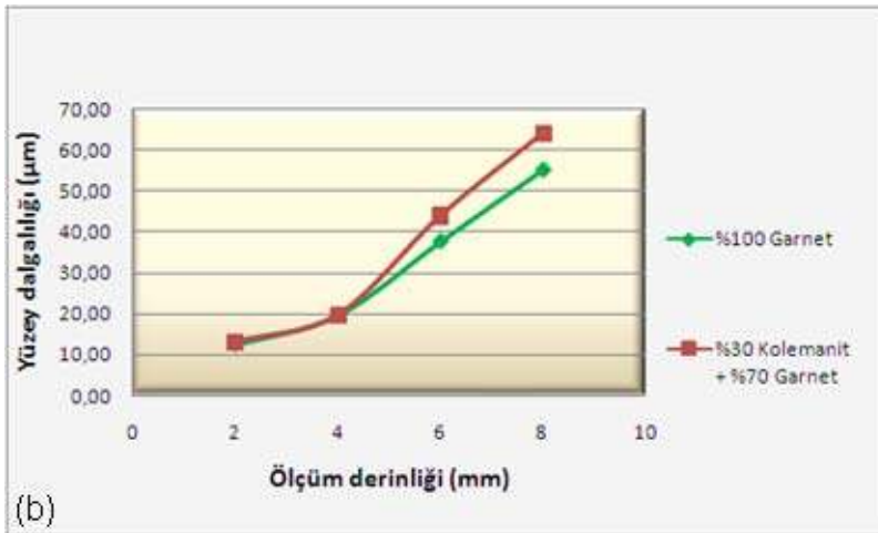
Şekil 6.18 (a) Ti6Al4V kesiminde kolemanit katkısıyla yüzey pürüzlülüğüne etkisi (b) Ti6Al4V kesiminde kolemanit katkısıyla yüzey pürüzlülüğüne etkisi yüzey dalgalılığına etkisi
