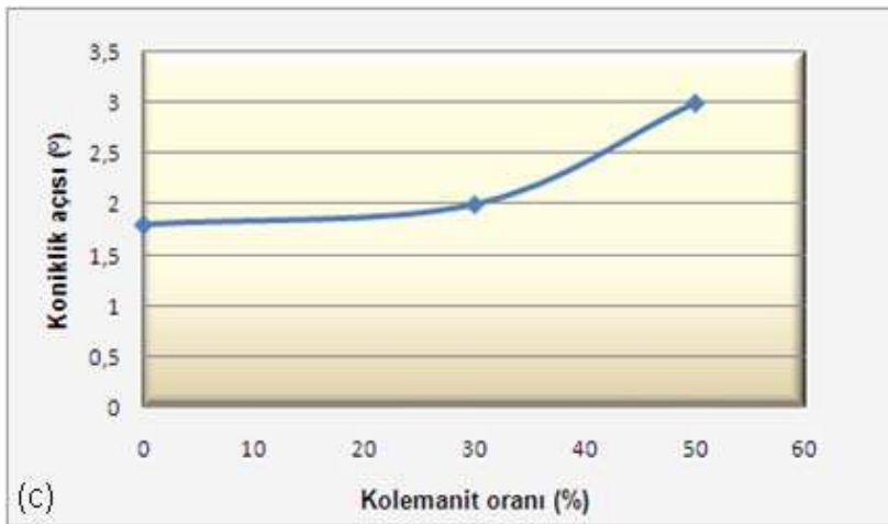
Şekil 6.14 (a) Al7075 kesiminde kolemanit katkısının yüzey pürüzlülüğüne etkisi (b) Al7075 kesiminde kolemanit katkısının yüzey dalgalılığına etkisi (c) Al7075 kesiminde kolemanit katkısının koniklik açısına etkisi
