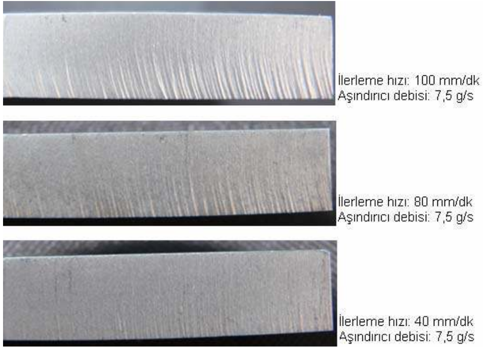
Resim 6.3 Kolanit ile Al7075 kesiminde 7,5 g/s aşındırıcı debisi ve farklı ilerleme hızlarıyla elde edilen yüzeyler
