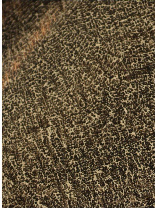
Şekil 8.3 Fazer 55 3. paso iç yapısı (10x)
