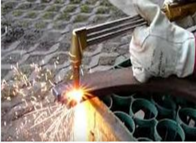
Şekil 2.5. Oksijen ile kesme işlemi
