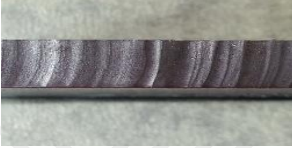
Şekil 2.21. Kesim hattı girdap çizgileri
