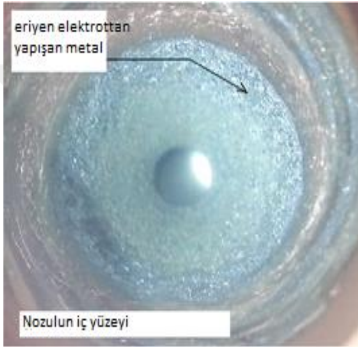
Şekil 4.12. Elektrottan nozulun iç yüzeyine eriyen metalin yapışması
