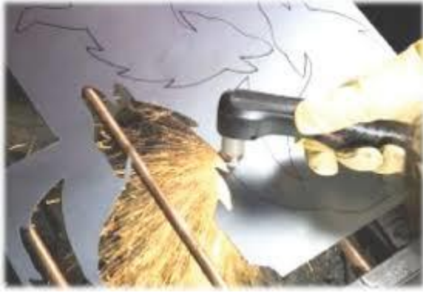
Şekil2.6. Plazma ile kesme
