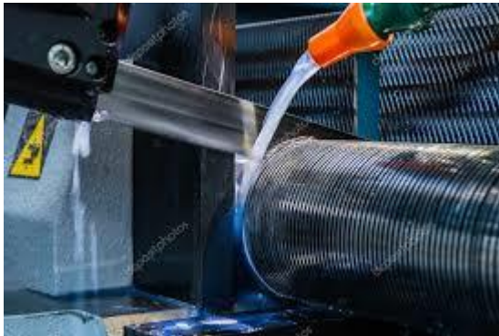
Şekil 2.1. Talaşlı kesme işlemi
