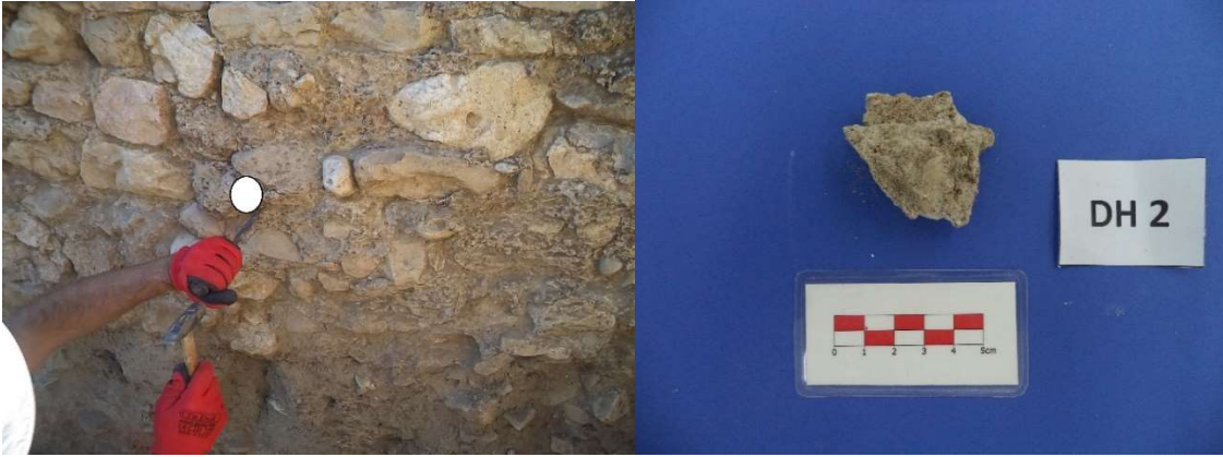
Şekil 3. 35. DH2 kodlu harç numunesi
