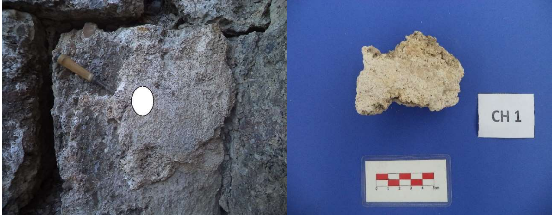
Şekil 3. 7. CH1 kodlu harç numunesi
