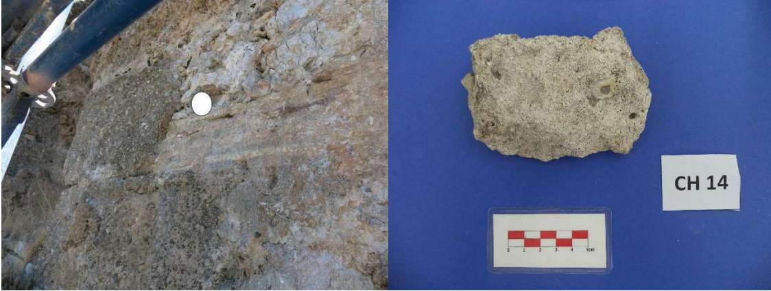
Şekil 3. 20. CH14 kodlu harç numunesi
