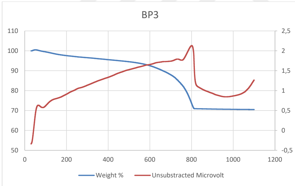
Şekil Ek-4. 4. BP3 numunesi TGA/DTA sonuçları
