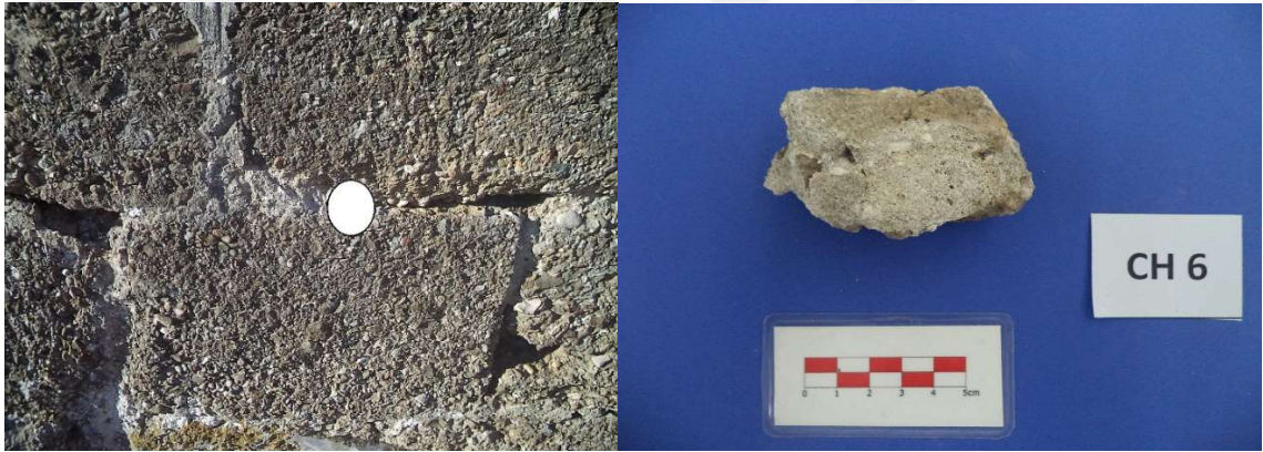
Şekil 3. 12. CH6 kodlu harç numunesi
