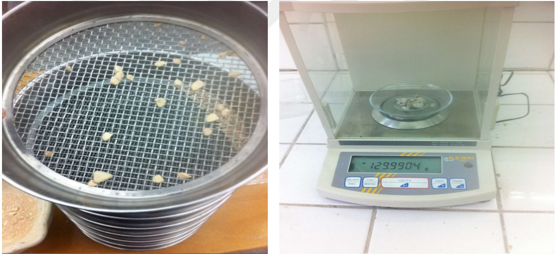
Şekil 3. 42. Asit kaybı sonrası yapılan elek analizi
