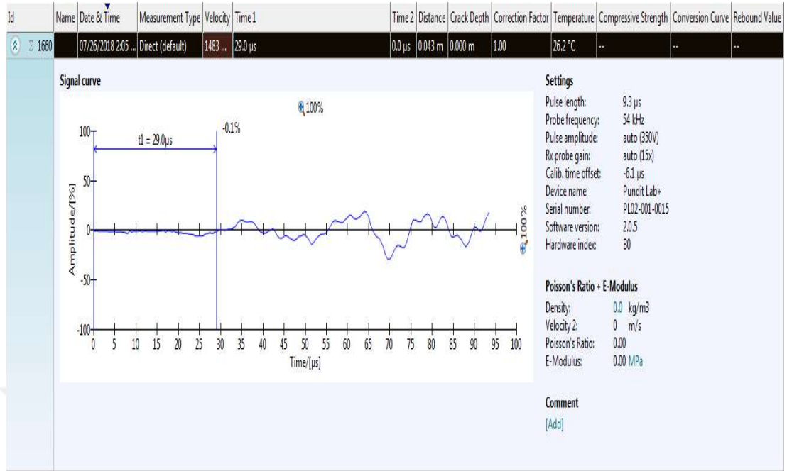
Şekil Ek-5. 5. ST3 tuğla ultrases grafiği
