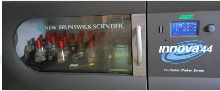
Şekil 4. 9. Çalkalamalı inkübatörde engelli erlenlerde \alpha -amilaz enzimi üretimi
