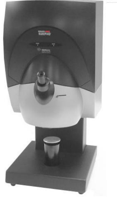
Şekil 3.8: Elrepho 2000 opaklık, parlaklık, beyazlık test cihazı
