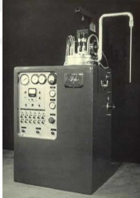
Fotoğraf 2.2. Collins helyum sıvılaştırıcı [Radebaugh, 2007].
