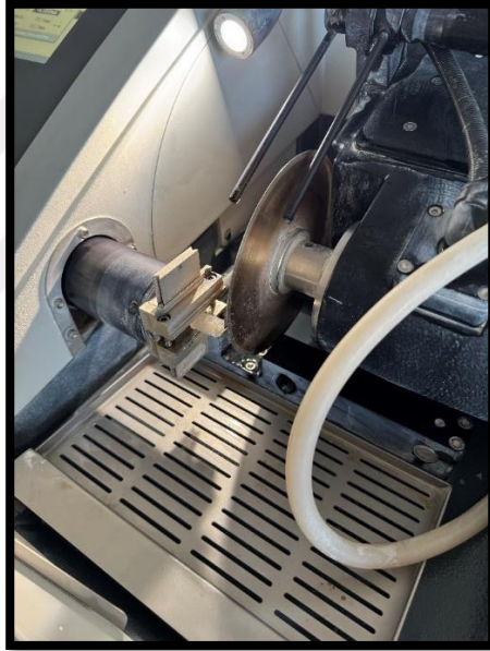
Şekil 3.12. Dentin disklerinin hassas kesme cihazında oluşturulması
