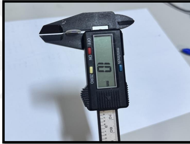
Şekil 3.16. Dentin disklerinin kalınlıklarının elektrikli kumpasla kontrolü
