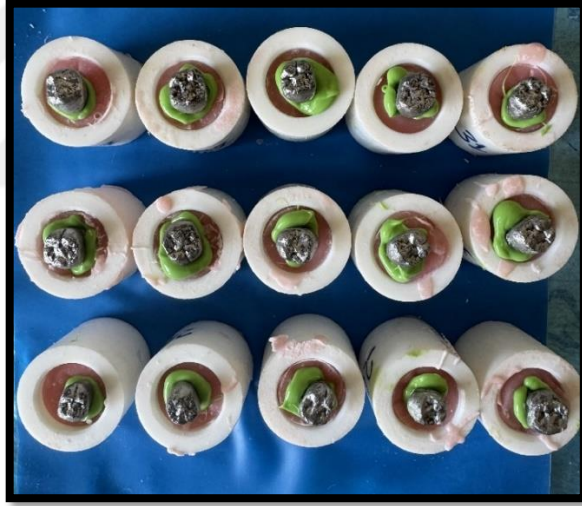
Şekil 3.8. Dişlerin akrilik bloklara gömülüp A tipi silikon uygulanmış hali (Silikon Temizlenmemiş)
