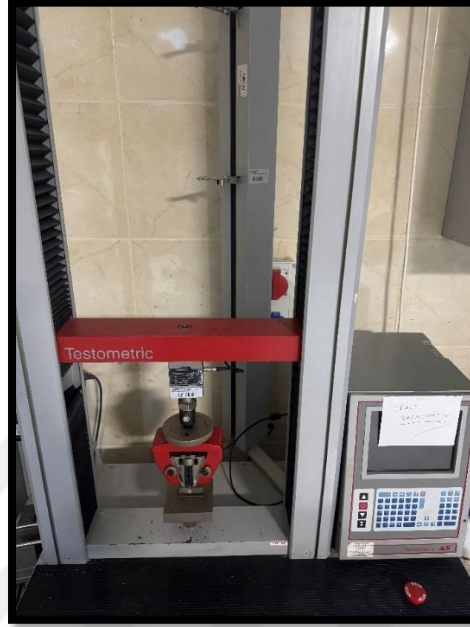
Şekil 3.17. Universal Testometrik Cihazı (Testometric M500, 25 kN; Rochdale, İngiltere)
