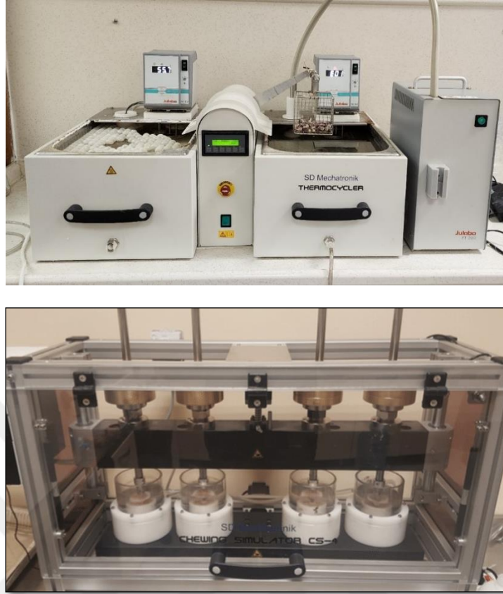
Şekil 3. 15. Termal Siklus Cihazı Ve Çiğneme Simülatörü İle Yaşlandırma
