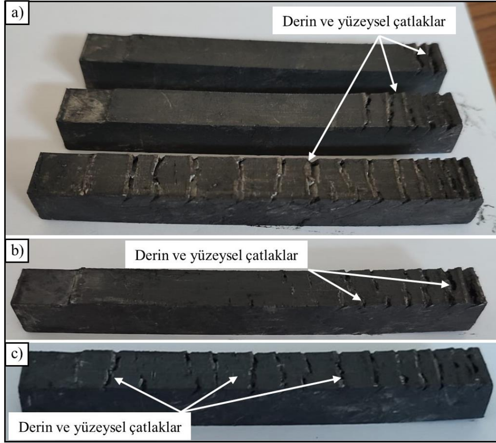
Şekil 10. Farklı sıcaklık ve hızlarda gerçekleştirilen ikinci paso EKAB deneyleri sonucu numunelerin görüntüleri: a) 200 °C, 0,5 mm/s, b) 200 °C, 0,25 mm/s, c) 210 °C’de 0,5 mm/s
