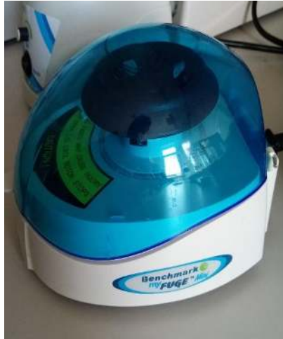
Figure 8.10. myFuge™ 8 Mini Centrifuge by Benchmark Scientific
