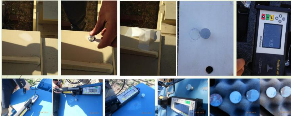
Resim 2.22. Yapışma Testi-Pull Off
