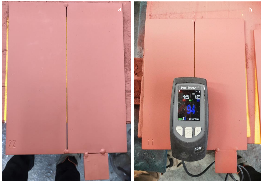
Resim 3.2. a) Malzemelerin astar uygulaması sonrası, b) Uygulama sonrası astar kalınlık ölçüm fotoğrafı
