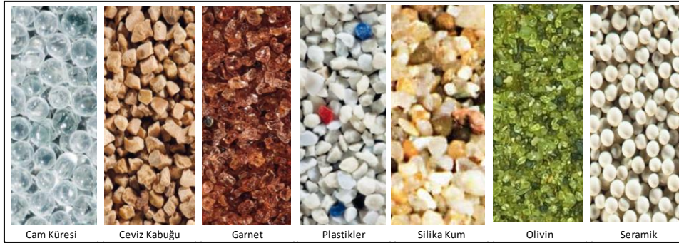
Resim 2.8. Metalik olmayan aşındırıcılar
