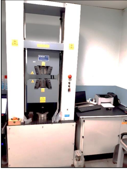
Resim 3.9. Alşa 30 ton MCK üniversal çekme cihazı
