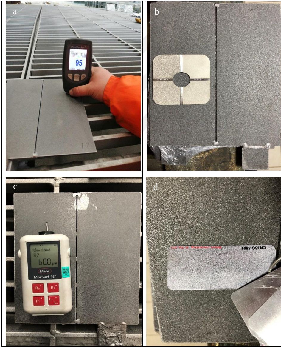
Resim 3.1. Kumlanmış malzeme fotoğrafları, a) iğne uçlu ile kumlama ölçümü, b) kumlama mukayese plakası, c) yüzey pürüzlülük ölçümü, d) kumlama yüzey mukayese fotoğrafı
