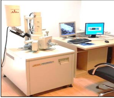
Resim 3.7. Jeol 6064 LV SEM cihazı
