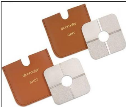
Resim 2.9. Yüzey pürüzlülüğü karşılaştırma plakası [52].
