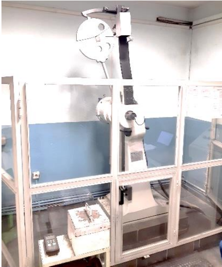
Resim 3.11. Darbe test cihazı
