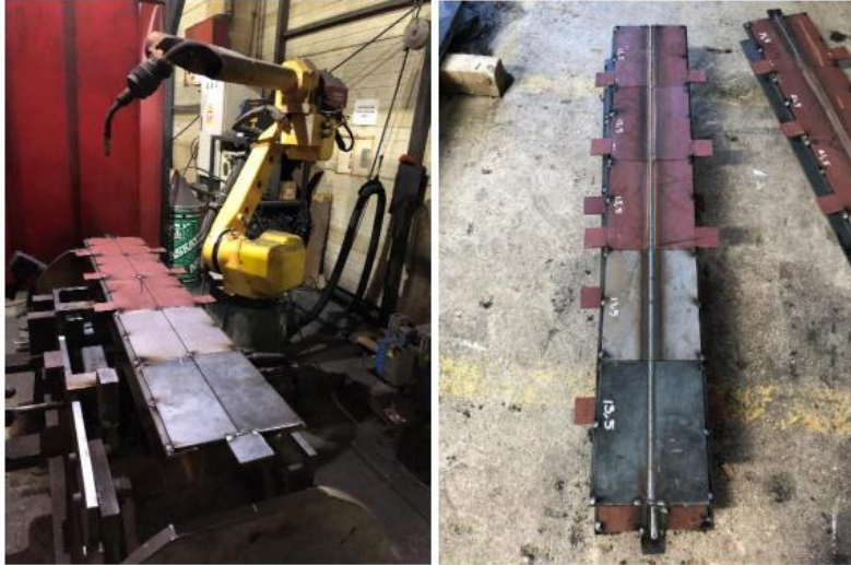
Resim 3.3. Numunelerin MAG kaynak uygulaması öncesi ve sonrası fotoğrafları
