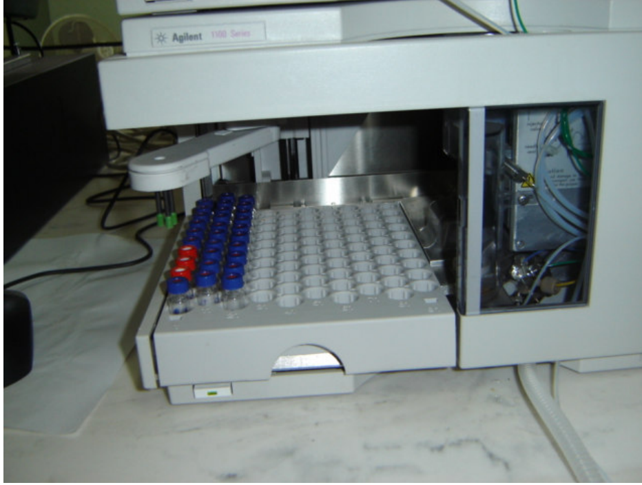
Şekil-13: HPLC sistemde standartlar ve numuneler
