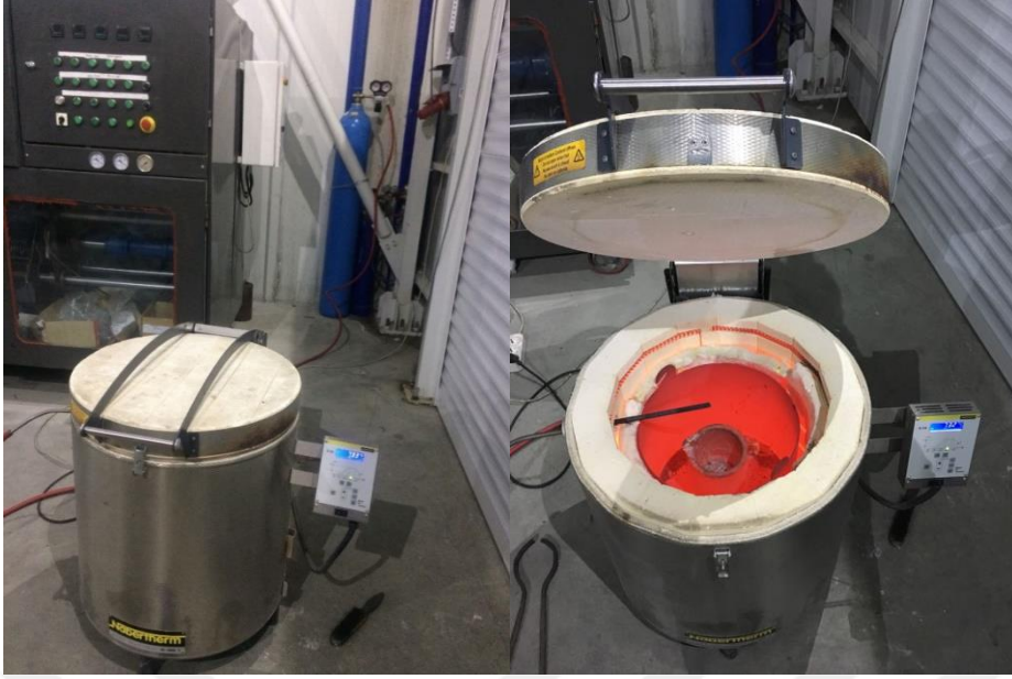
Şekil 5.1. Hazırlanan alaşımların ergitilmesi.
