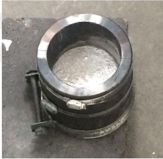
Şekil 5.2. Kokil kalıba döküm.
