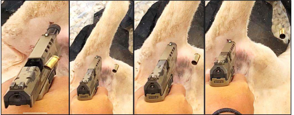
Resim 2: Kovanın yarı otomatik tabancadan dışarı atılması.
