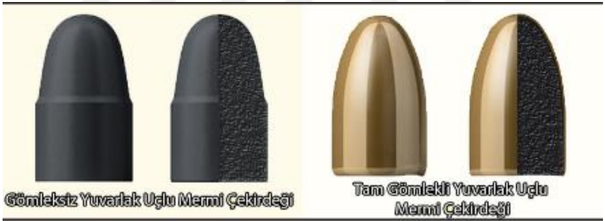
Resim 7. Gömlekli ve gömleksiz çekirdekler (36).
