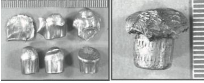
Resim 23. Tabanca mermisinde deformasyon (13).
