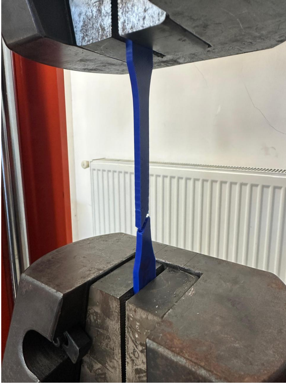
Şekil 3.2. Çekme Testi Kırılmış Polimer Numune
