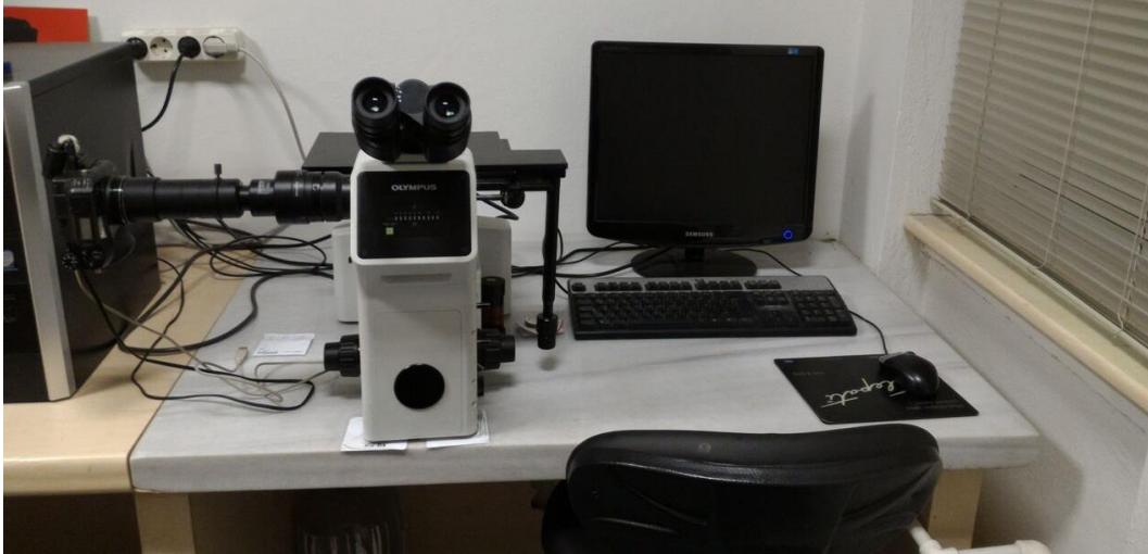
Şekil 4.9: Metalografi çalışmalarında kullanılan optik mikroskop.
