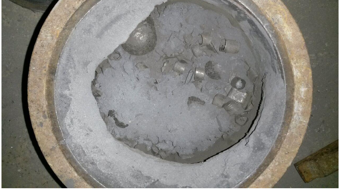
Şekil 3.16: Bilyalı değirmende öğütülmüş piller.
