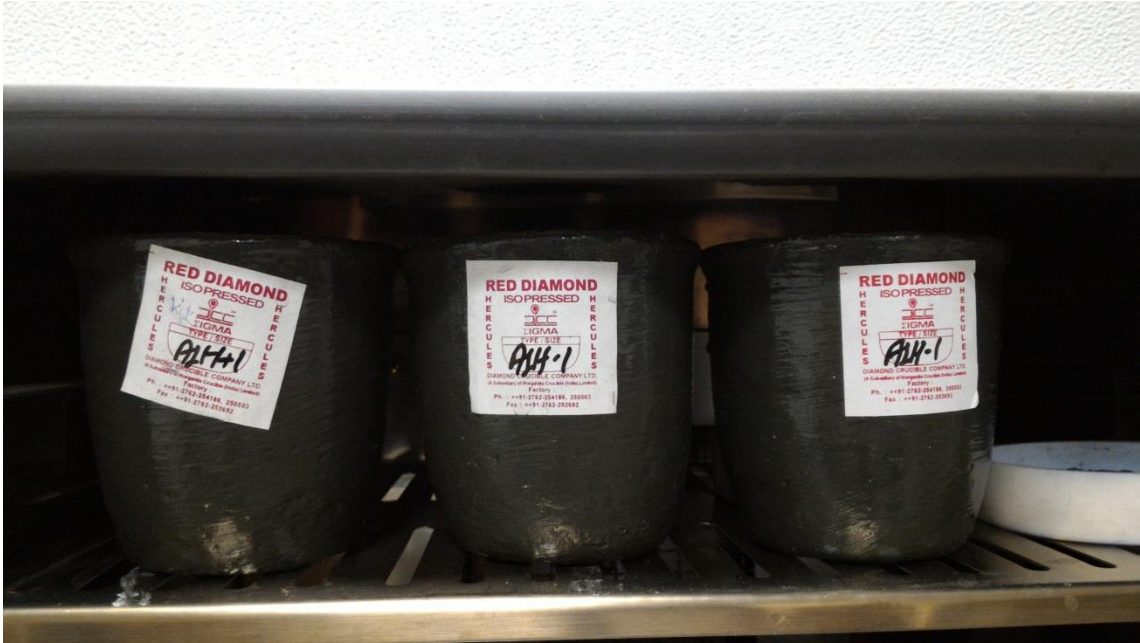
Şekil 3.12: Ferromangan üretiminde kullanılacak grafit potalar.
