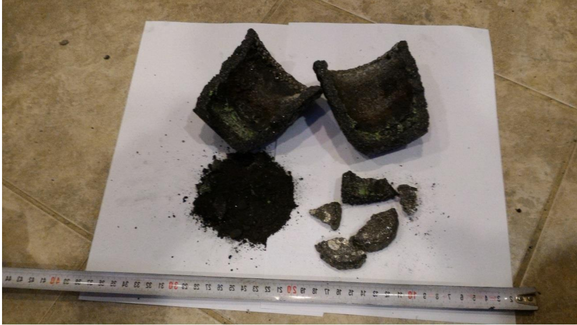
Şekil 3.19: Ferromangan üretiminde kullanılan pota, metal ve cüruf fazları.
