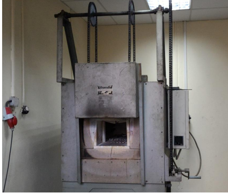
Şekil 3.10: Zn uçurma işleminin gerçekleştirileceği fırın.
