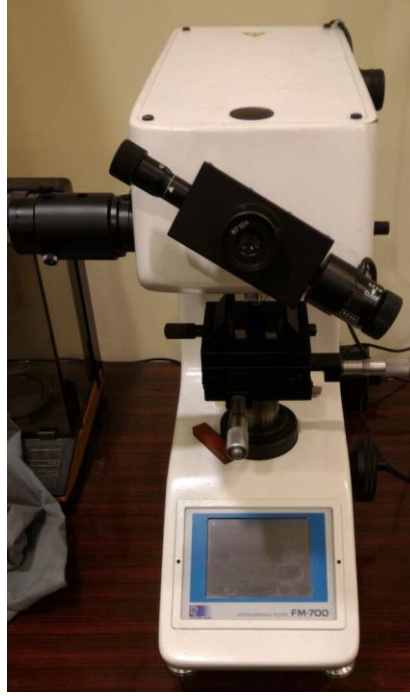
Şekil 4.10: Vickers sertlik ölçüm cihazı.
