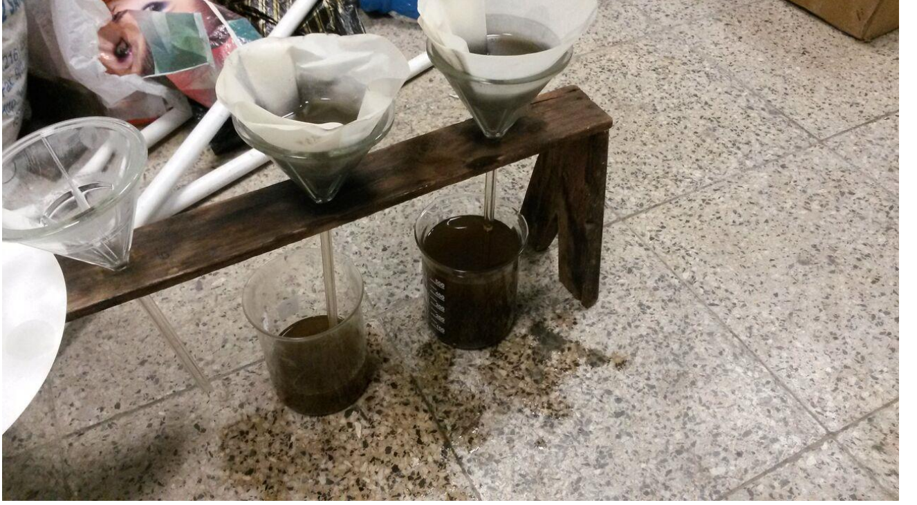
Şekil 3.17: KOH giderme sonrasında gerçekleştirilen süzme işlemi.
