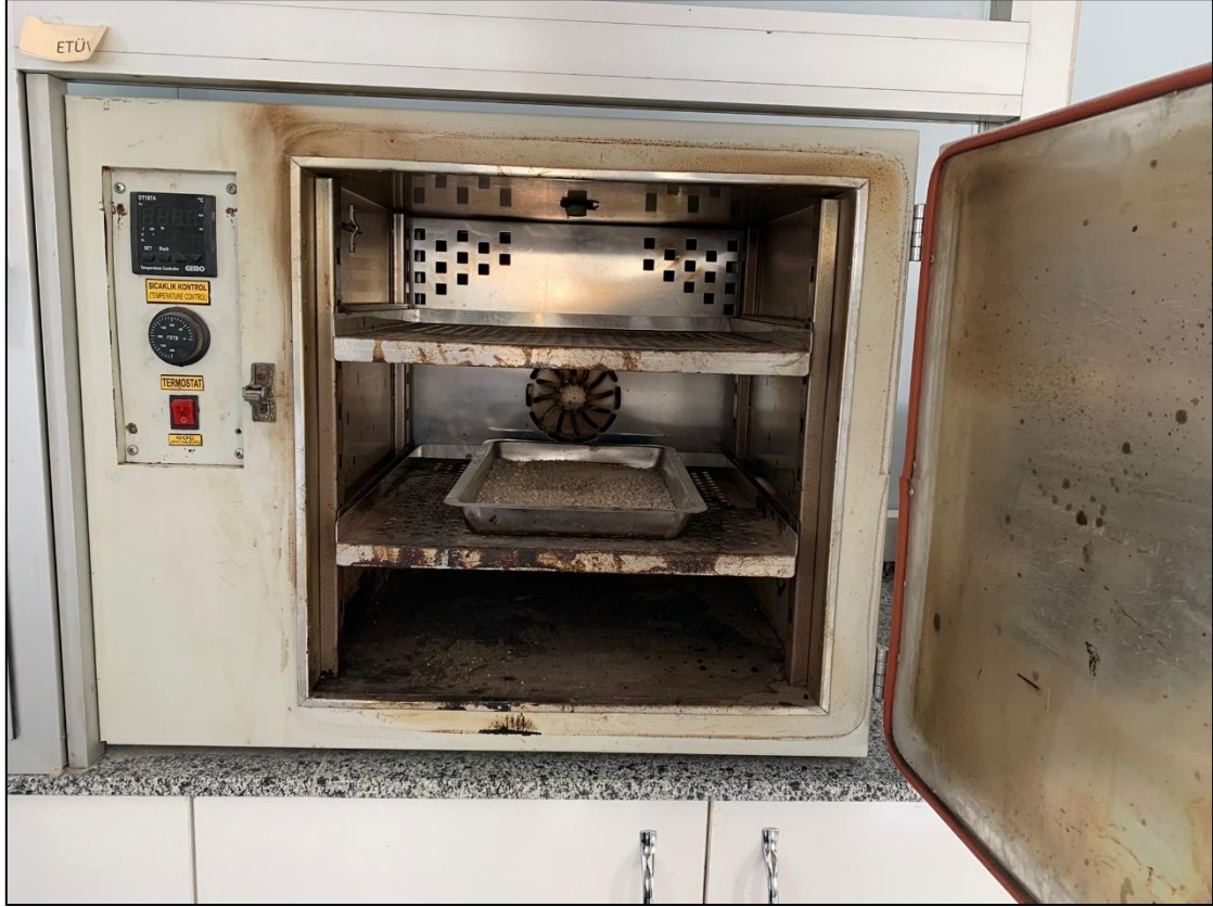
Resim 3.3 Isıtma kaybı deneyinde kullanılan etüv.
