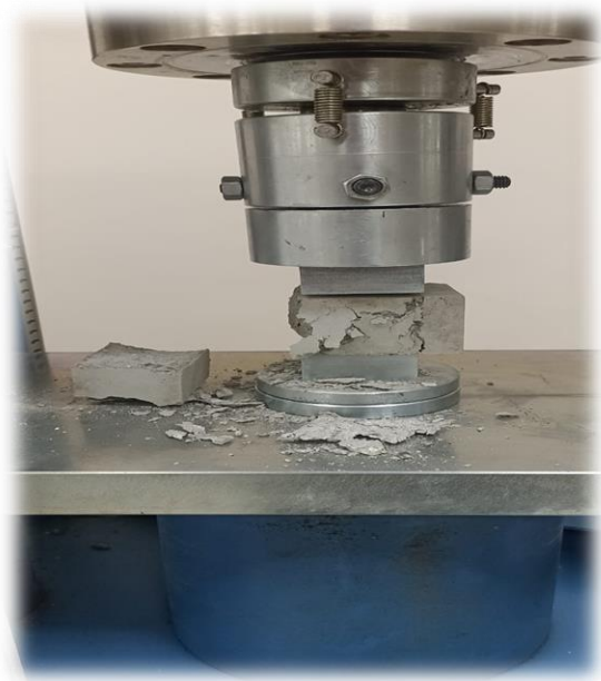
Şekil 4.4. Basınç dayanımı deneyi sonrasında kırılan geopolimer harç numunesi
