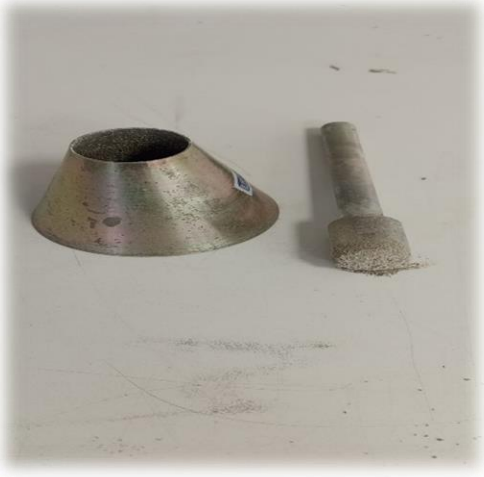
Şekil 3.17. İnce agregada özgül ağırlık ve su emme oranı tayininde kullanılan kesik koni
