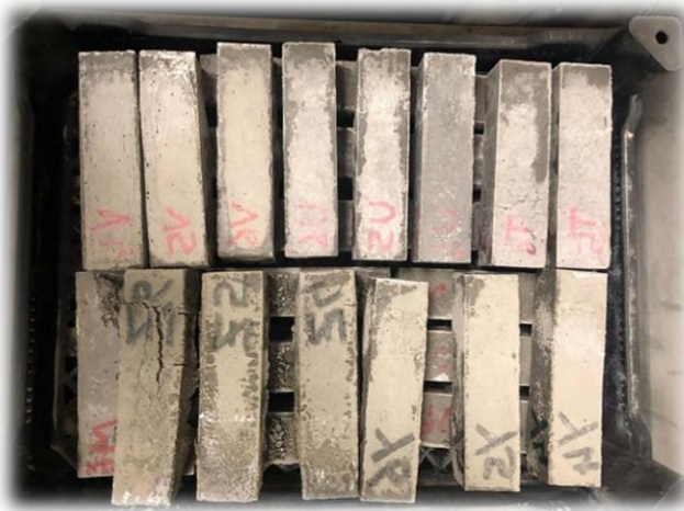
Şekil 3.34. Numunelerin donma-çözülme cihazı içerisindeki görüntüsü
