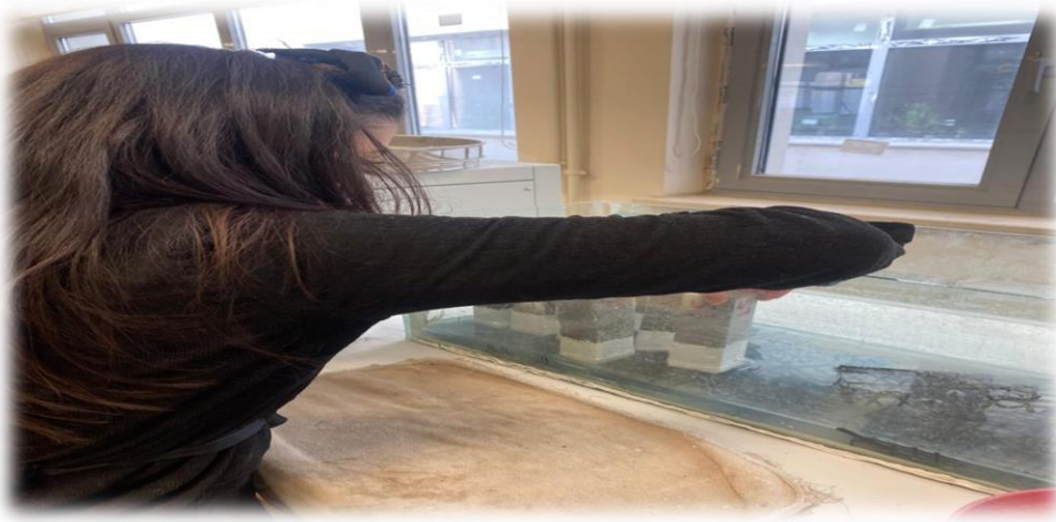
Şekil 3.33. Kılcal geçirimlilik tayini için kullanılan su havuzu
