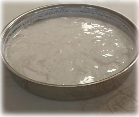
Şekil 3.18. Doygunluk işlemi için su içerisinde bekletilen atık mermer tozu numunesi
