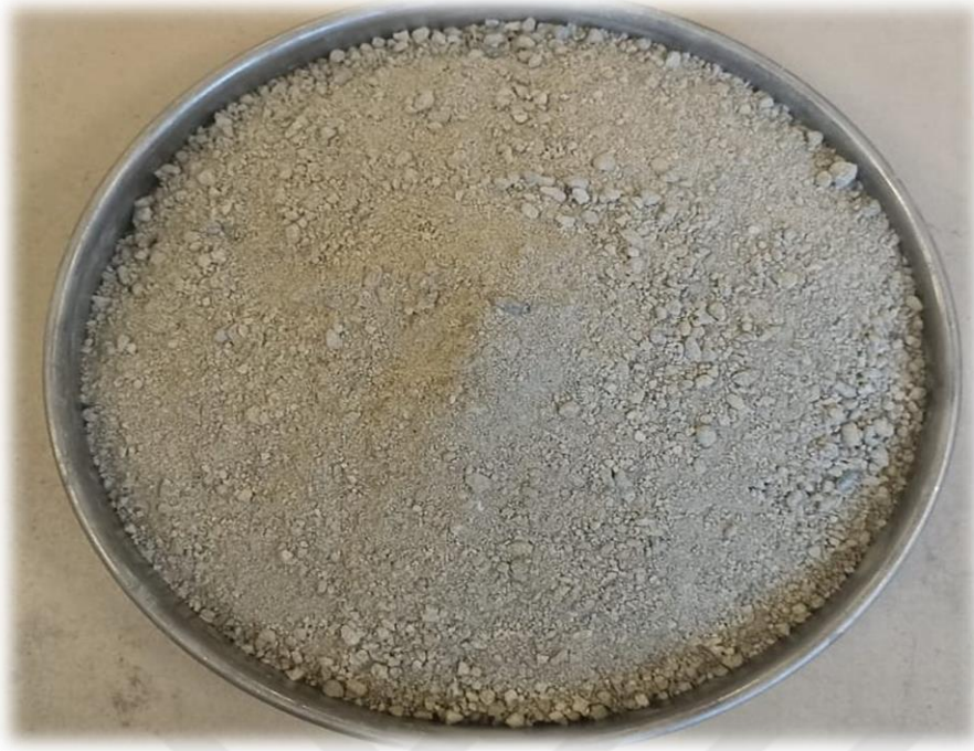
Şekil 3.9. Yıkıntı atığının öğütülmüş hali
