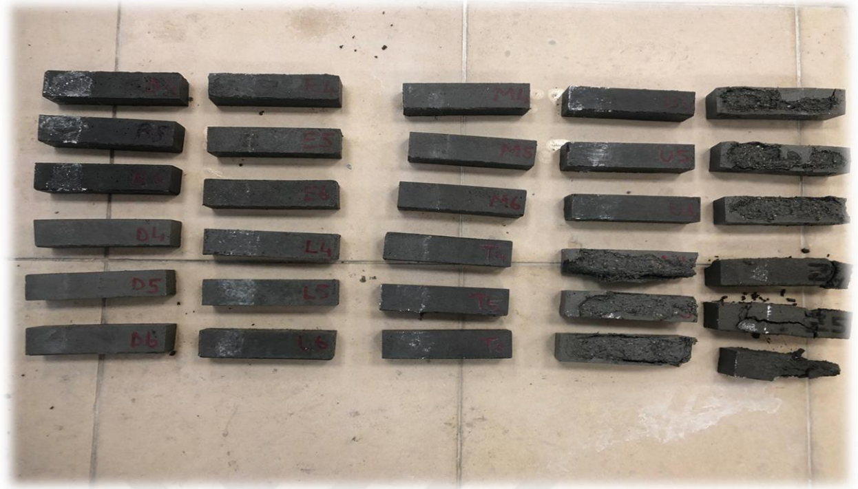
Şekil 4.9. Numunelerin donma-çözülme deneyi sonrası görüntüsü
