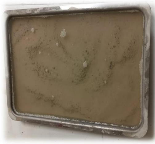
Şekil 3.19. Doygunluk işlemi için su içerisinde bekletilen yıkıntı atığı numunesi
