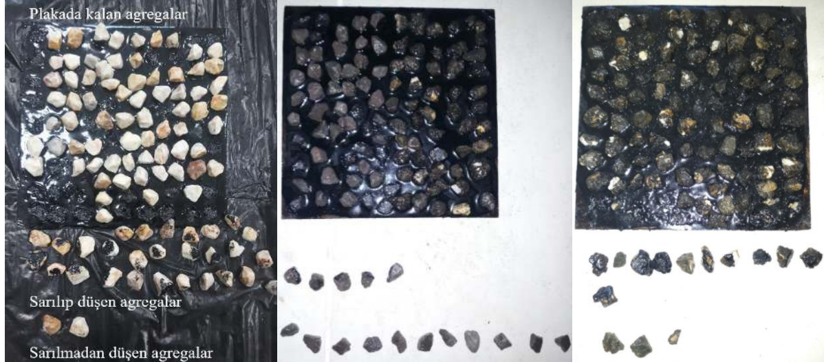
Şekil 4.11. Vialit deneyi numunelerinin kontrolü
