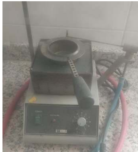
Şekil 4.8. Parlama noktası deney aleti
