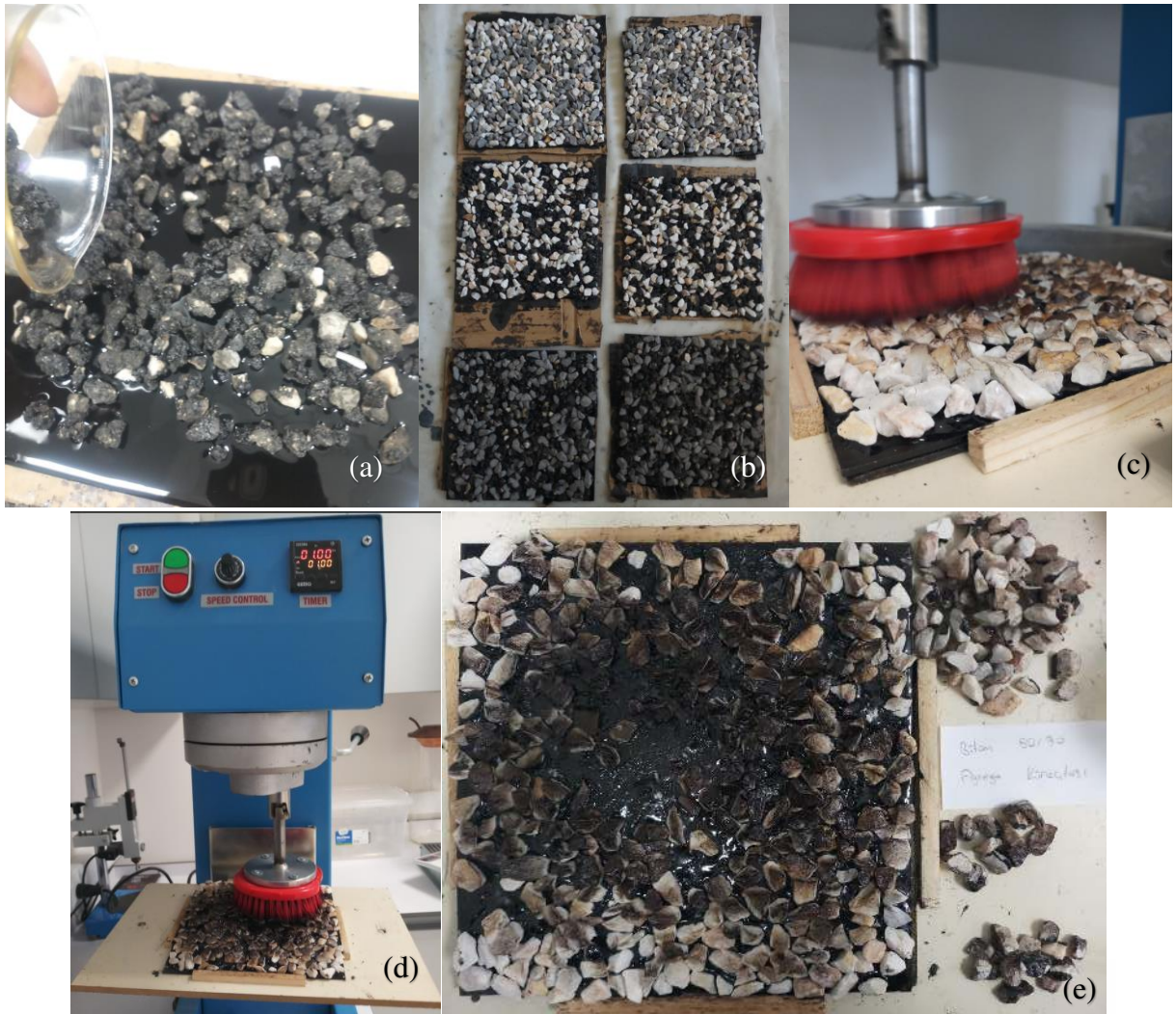
Şekil 4.13. Süpürme testi, (a) Agregaya uygulaması, (b) Süpürme testi numuneleri, (c) Süpürme işlemi, (d) Süpürme testi cihazı, (e) Deney sonucu numune görünümü
