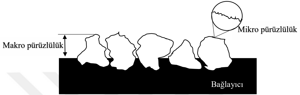
Şekil 2.11. Makro ve mikro pürüzlülük özellikleri
