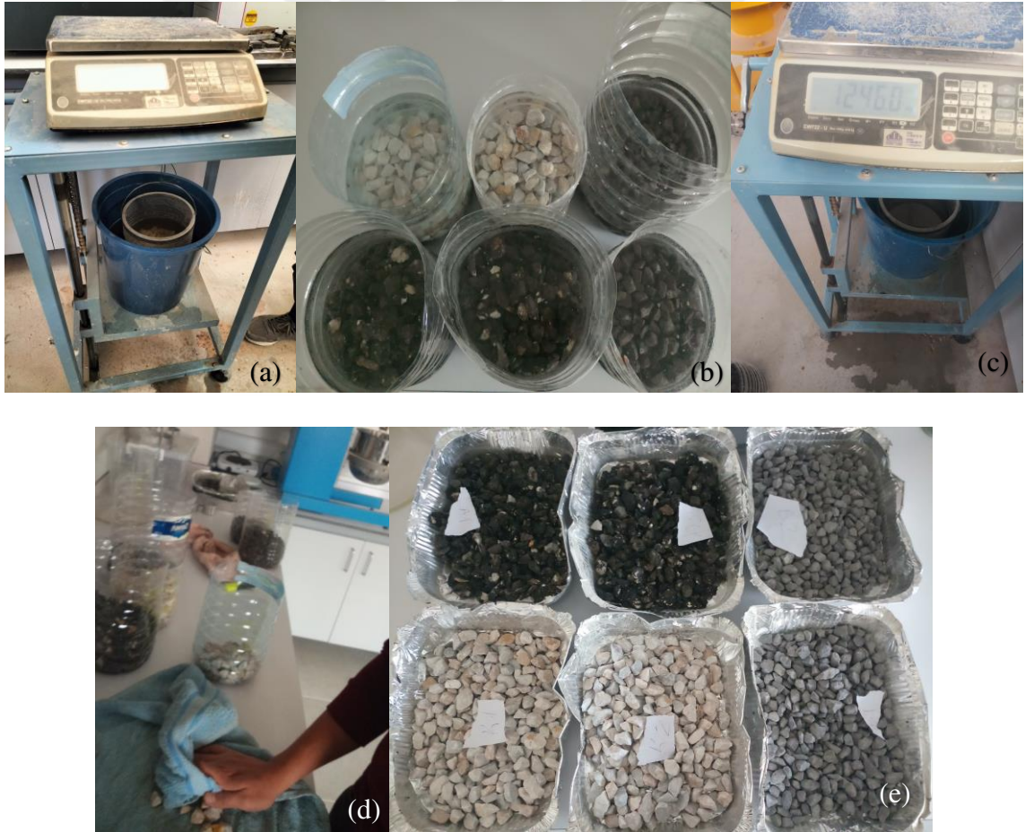
Şekil 4.3. Kaba agrega özgül ağırlık deneyi a) Özgül ağırlık sehpası, b) Numunelerin 24 saat su içerisinde bekletilme işlemi c) Su içerisinde agrega ağırlığı tartımı, d) Agregaların yüzey kurulum işlemi, e) Etüvden çıkarılmış kuru agregalar
