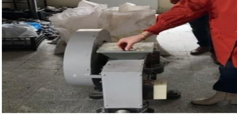
Şekil 11. Atık Beton Numunelerini Öğütme İşlemi
