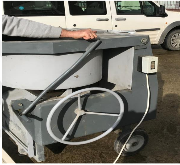
Şekil 19. Beton Karma Makinası
