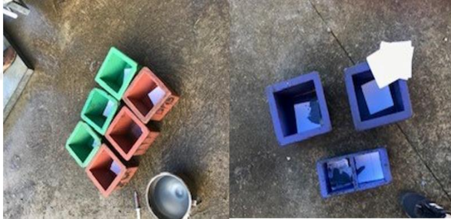
Şekil 18. Beton Numune Kalıpları
