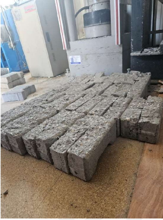
Şekil 3.25. Yarmada Çekme Deneyi sonucu kırılmış numuneler
