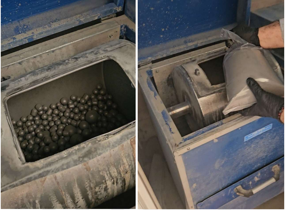
Şekil 3.8. Bilyalı değirmenin tamburu ve külün tambura aktarılması
