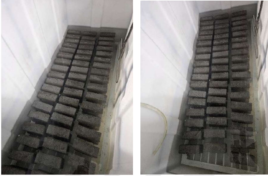
Şekil 3.18. Kilitli beton parke taşlarının kür havuzunda bekletilme süreci
