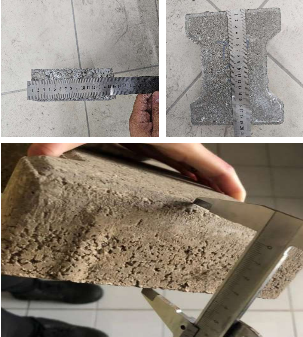
Şekil 4.2. Kilitli beton parke taşı boyutları ölçümü
