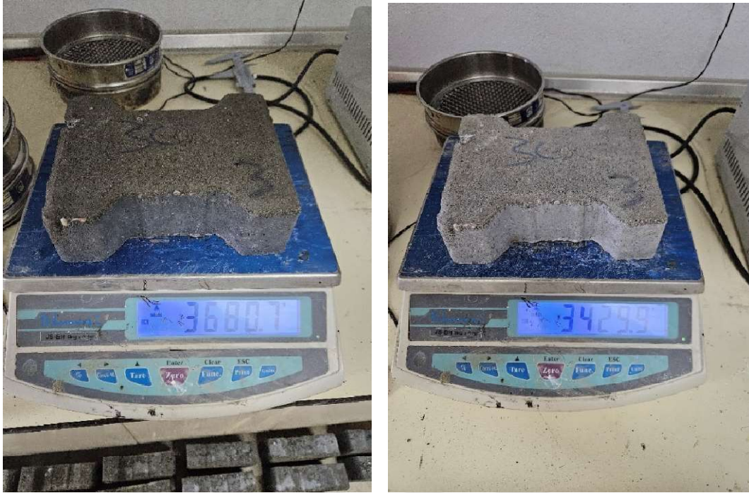
Şekil 4.3. Numunelerin Doygun kütlede(M1) ve Kuru kütledeki(M2) ağırlıkları
