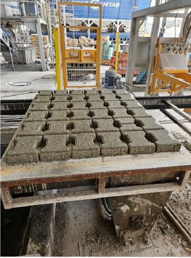
Şekil 3.16. Kilitli beton parke taşı üretim süreci
