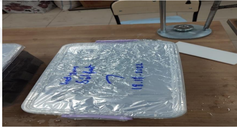
Şekil 3.2. Sodyum sülfat çözeltisine maruz bırakılan numunelerin muhafazası
