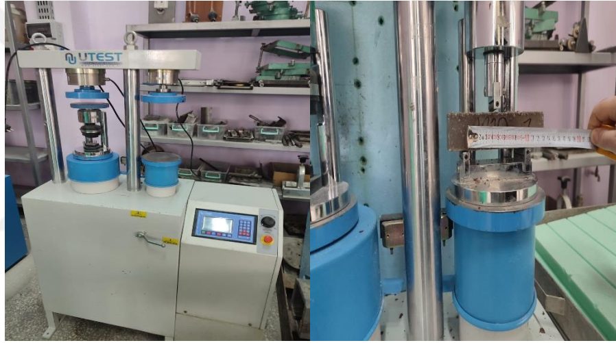
Şekil 3.11. Polimer beton numuneleri eğilme dayanım testi ve deney cihazı
