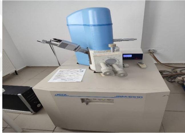
Şekil 3.15. SEM görüntüleme analizi ve deney cihazı
