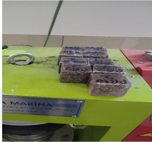
Şekil 4.2. Basınç dayanımına tabi tutulan polimer beton numuneleri
