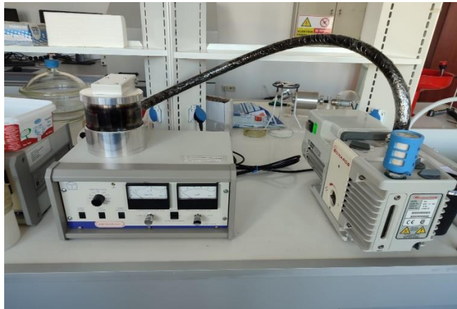
Şekil 3.16. Sputter coater kaplama cihazı
