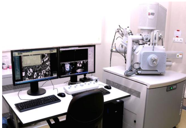
Şekil 3.13. SEM analizinde kullanılan Quanta 650 Field Emission cihazı
