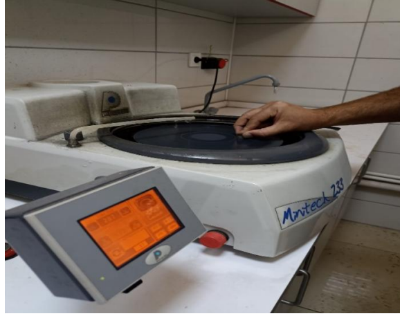
Şekil 3.9. Minitech Parlatma Cihazı ve parlatma işlemi
