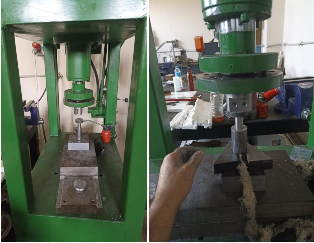
Şekil 3.5. Tozların sıkıştırılmasında kullanılan hidrolik pres
