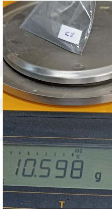
Şekil 3.4. Karıştırıldıktan sonra tartılan %8 karbon fiberli Al7075 alaşım tozu
