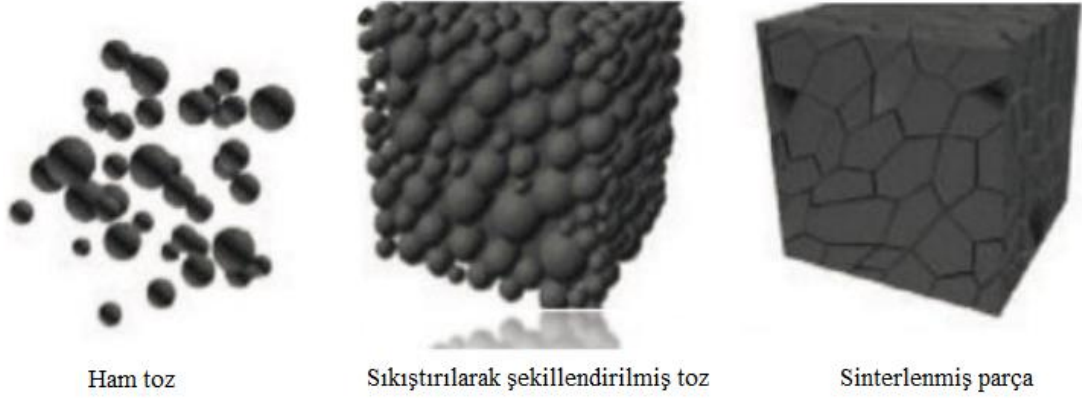
Şekil 2.9. Toz işleme aşamasında sinterleme sonrası yapının değişimi (HG ve Xavior, 2018)
