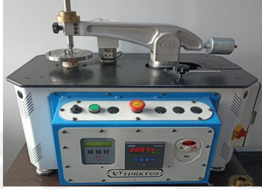
Şekil 3.11. Pin-on-disk aşınma testi düzeneği
