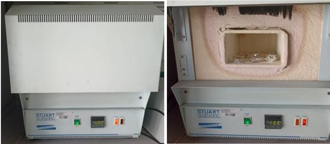
Şekil 3.7. Stuart Scientific sinterleme fırını ve sinterleme işlemi
