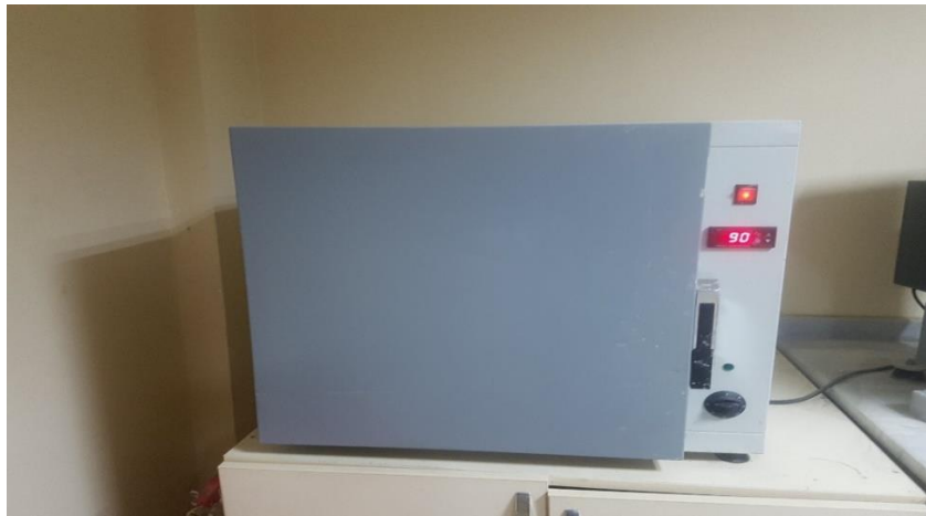
Şekil 12. Yüksek sıcaklık küründe kullanılan etüv.
