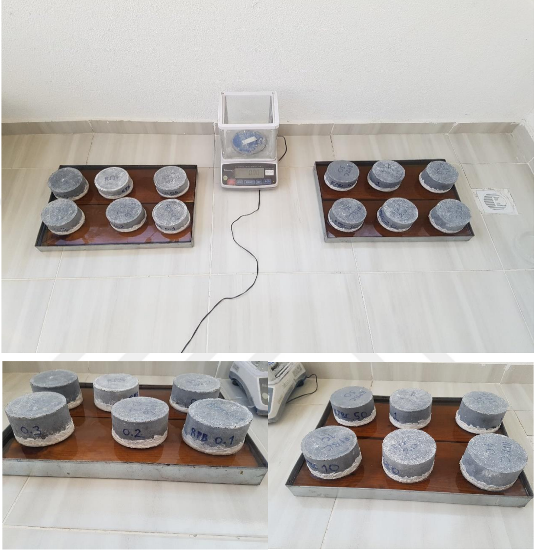
Şekil 19. Kılcal Su Emme deney düzeneği.
