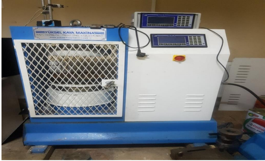
Şekil 11. Deneyde kullanılan basınç makinası.
