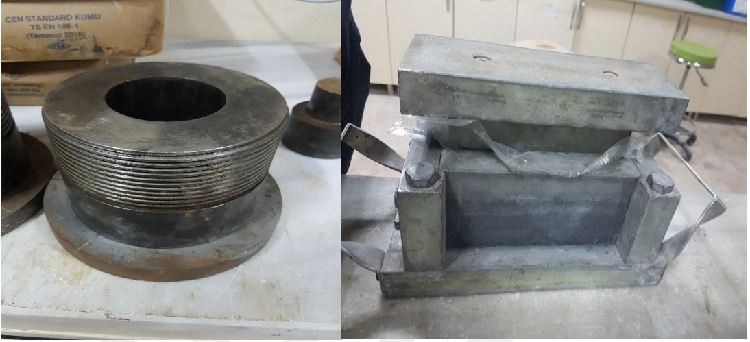
Şekil 10. Dikdörtgen prizma ve silindir numunelerin sıkıştırılması için tasarlanan kalıplar.
