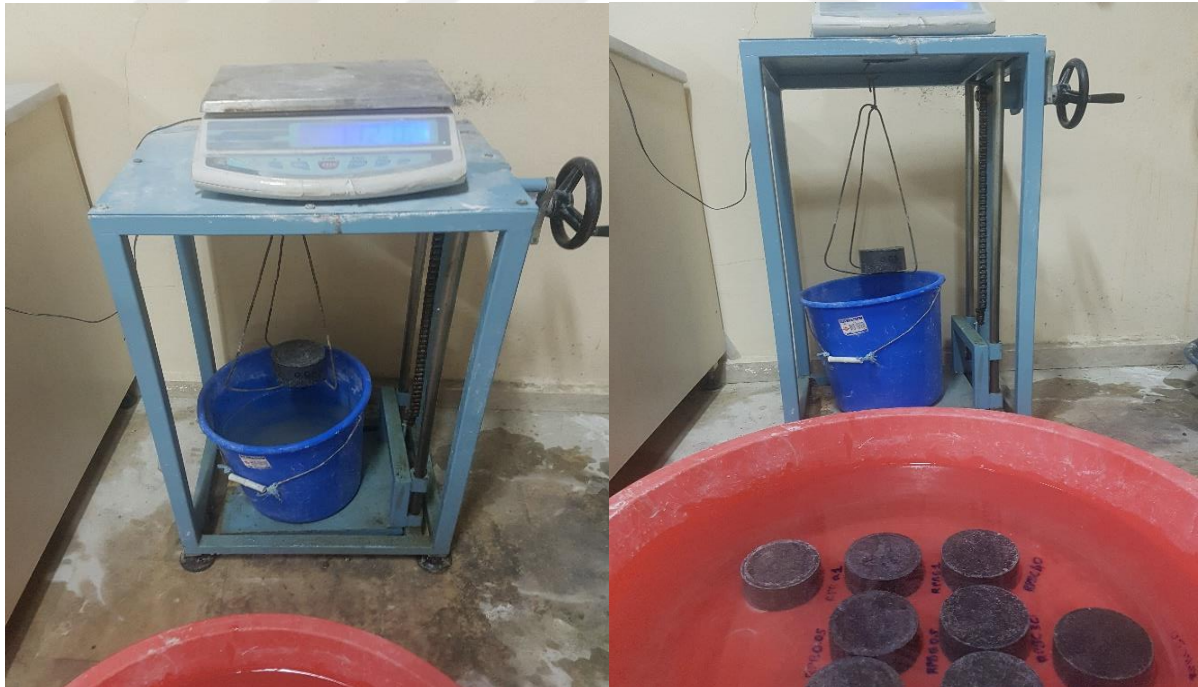
Şekil 16. Su içerisindeki havadaki ağırlıkları tartılan tartı.
