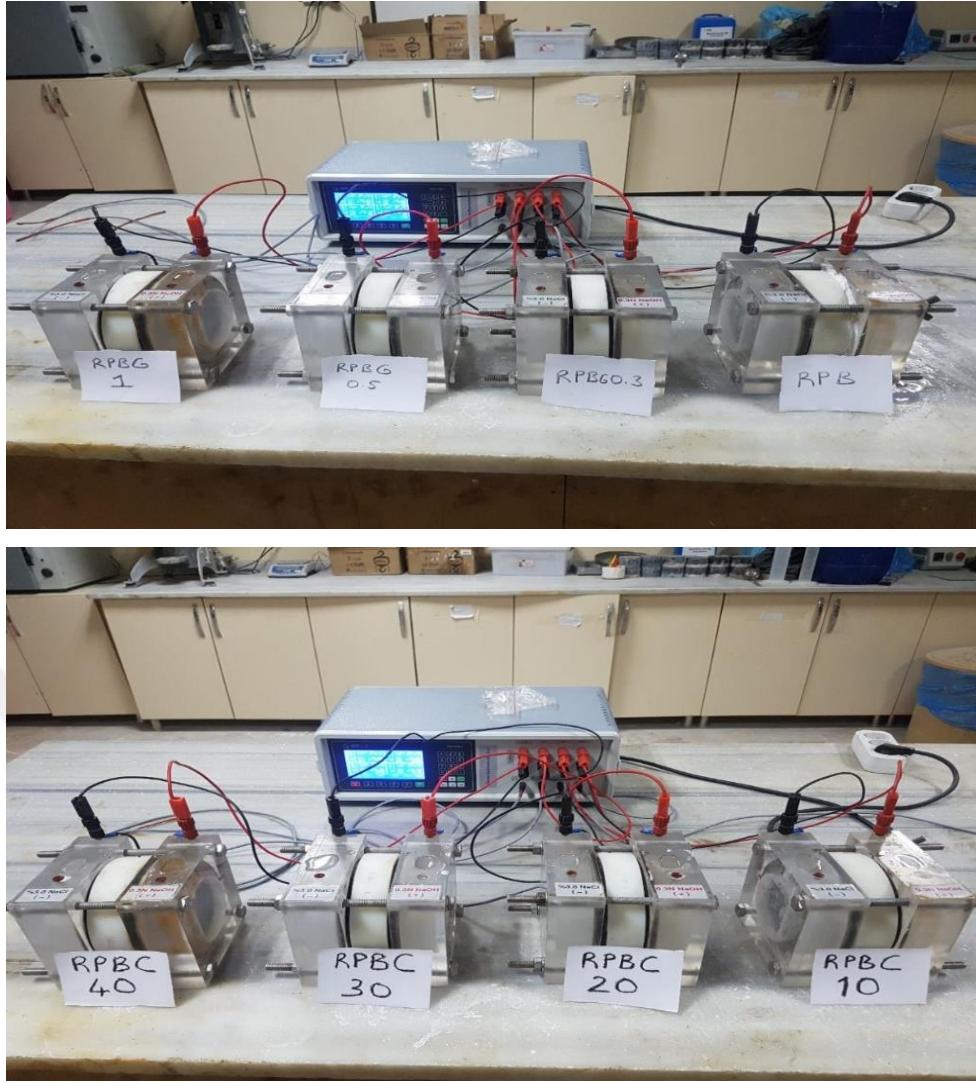
Şekil 20. Hızlı klorür geçirimliliği cihazı.
