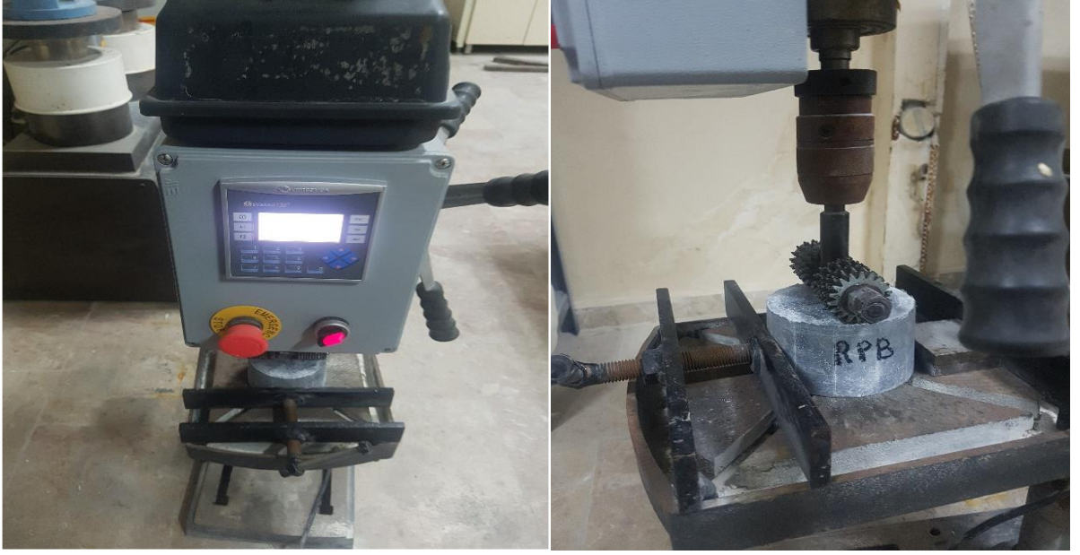
Şekil 21. Aşınma deney düzeneği.
