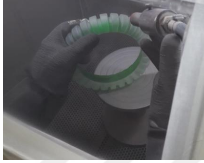
Şekil 7.46. Kumlama işleminin uygulanması
