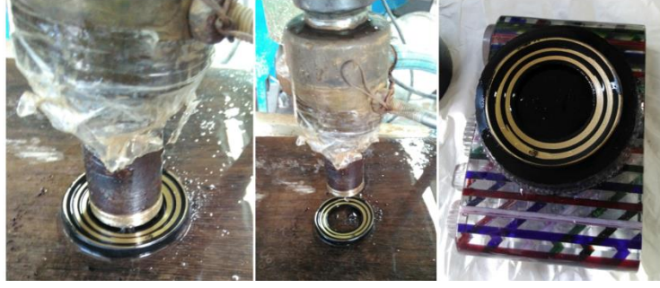
Şekil 7.20. Fotoğraf makinesi lensinde kullanılacak camın matkap yardımı ile delinmesi Fotoğraf: Özge Biçer tarafından çekilmiştir
