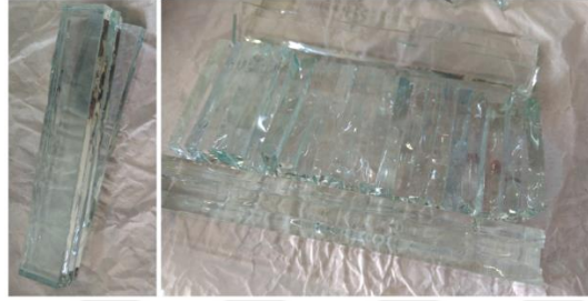
Şekil 7.1. Pencere camlarının istenilen boyutta kesilmiş hali
