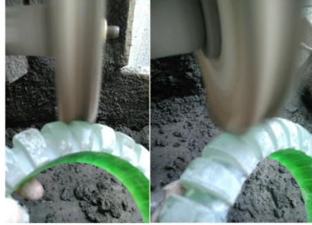
Şekil 7.47. Bez profilde açma işleminin gerçekleştirilmesi
