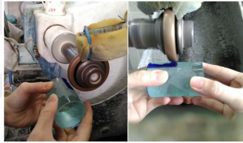
Şekil 7.26. Camın elmas aşındırıcıda şekillendirilmesi
