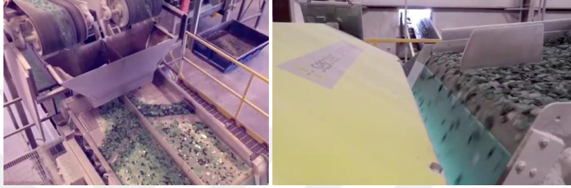
Şekil 5.8. Camların kırılma işlemleri
