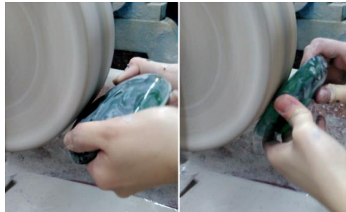
Şekil 7.38. Camın seryum işlemine tabi tutulması
