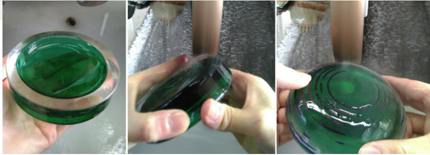
Şekil 7.35. İmalat atığının ovalleştirilmesi
