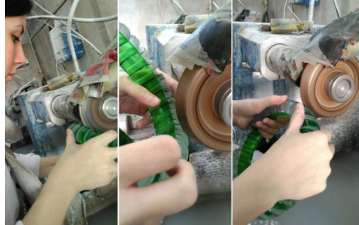
Şekil 7.45. Açılı elmas profilinde pah alma işleminin uygulanması
