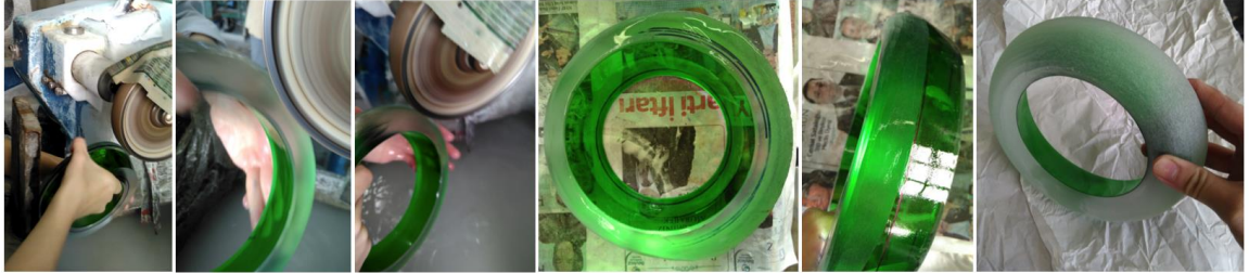
Şekil 7.32. Kaba elmas aşındırıcı ile cama istenilen şeklin verilmesi (a) ve düzeltilmiş görüntüleri (b)
