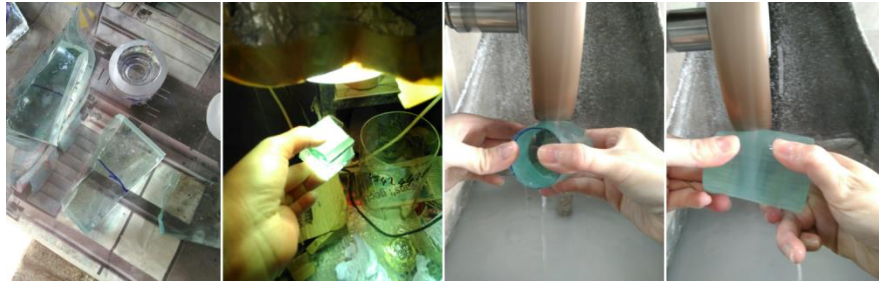
Şekil 7.24. Camların yapıştırma (a) ve şekillendirme işlemi (b)
