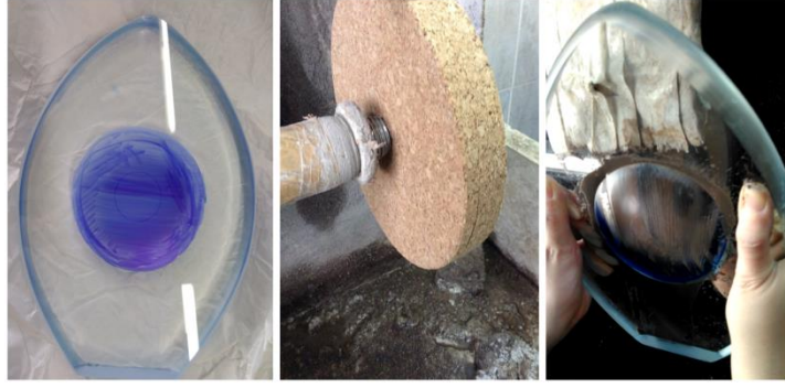
Şekil 7.57. Parlatma işleminin mantar kafalarda gerçekleştirilmesi işlemi
