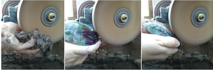
Şekil 7.37. Camın parlatılma işleminin uygulanması
