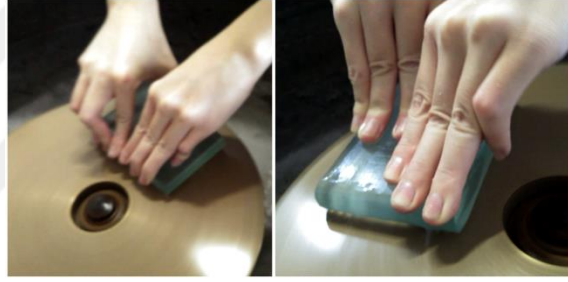
Şekil 7.6. 46 gritlik elmas taşında düzeltilen camın yatay diskte pürüzsüz hale getirilmesi
