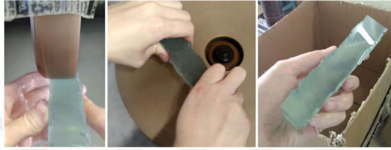
Şekil 7.3. Camların 46 gritlik elmas taşında rodajlama işleminden (a) sonra yatay diskte düzeltilmesi (b), düzeltilmiş hali (c)
