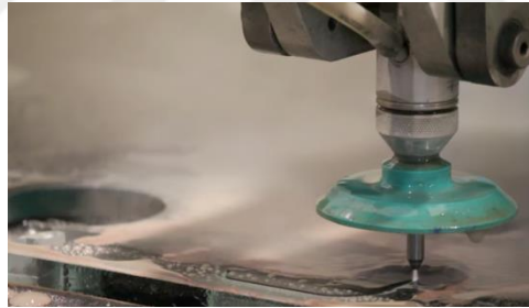
Şekil 3.33. Su jeti ile kesim yapılması
