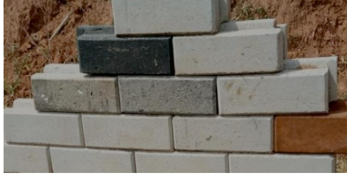
Şekil 5.20. Aimable Mutabazi'nin atık cam kullanarak oluşturduğu tuğla örnekleri
