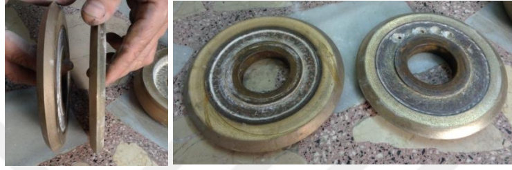
Şekil 3.10. Açılı elmas disk profili
