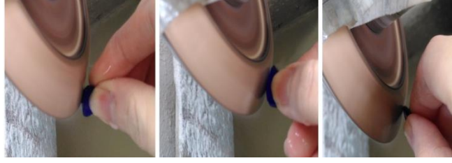
Şekil 7.60. Şekillendirilme işlemi yapılmış camlara pah alma işleminin uygulanması
