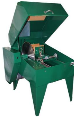
Şekil 3.24. Kapaklı dilim testere
