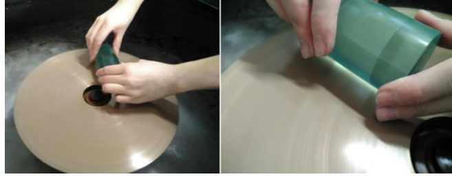
Şekil 7.25. Camların yatay diskte düzeltilme işlemi
