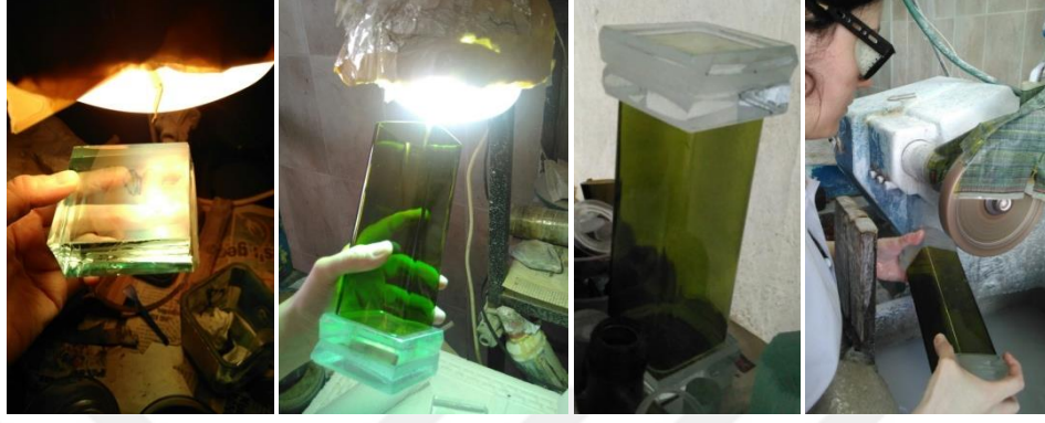
Şekil 7.68. Laminasyon (a) ve aşındırma işlemi (b)
