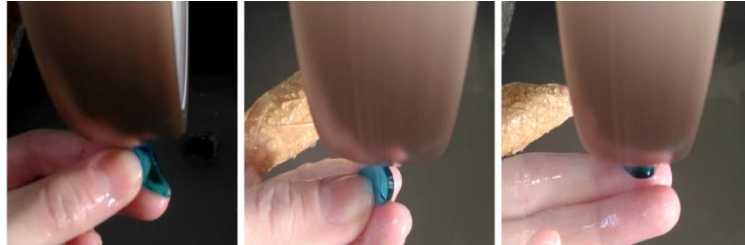
Şekil 7.59. Kesilen füzyon camlarının 46 gritlik elmas taşında şekillendirilmesi
