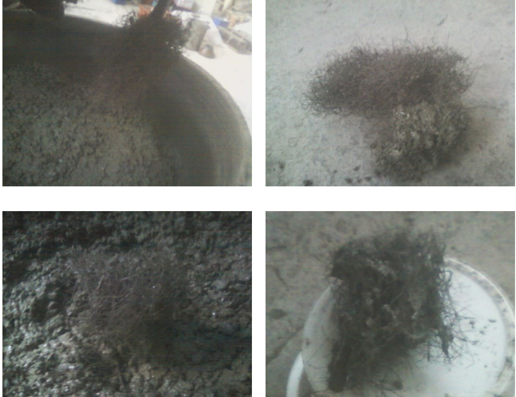
Şekil 3.5 : Beton üretimi sırasında topaklanan atık çelik lifler. (üstte B20 altta C60 deneme karışımları)
