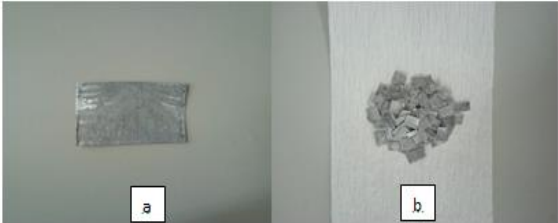
Şekil 3.4: Temizlenmiş ve kesilmiş metalik çinko. (a: Mekanik ve kimyasal temizleme işlemi sonrası elde edilen çinko levha, b: Küçük boyutlar halinde kesilmiş olan ve deneylerde kullanılan metalik çinko).
