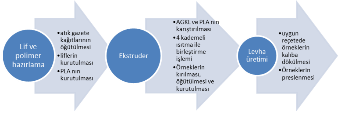
Şekil 3. Lignoselülozik Dolgu Maddeli Termoplastik Kompozit Levha Üretim Şeması
