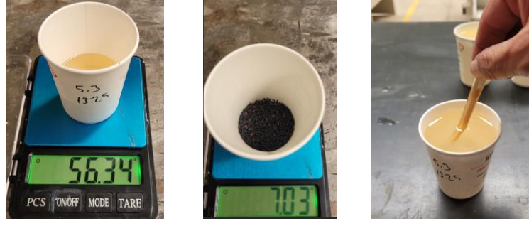
Şekil 3.9. Atık kauçuk ve epoksi reçine karışımlarının hazırlanması
