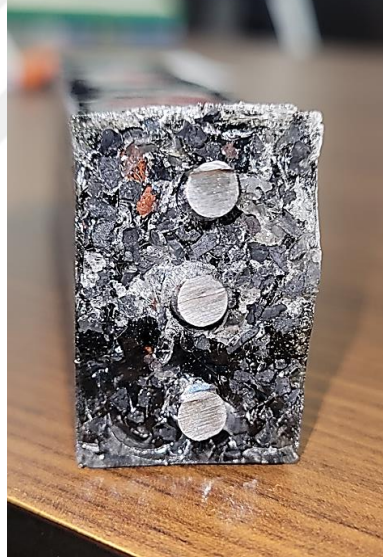
Şekil 4.10. Deney numunesinin kırılma yüzeyi, fiberler deney sonrası kesilmiştir.
