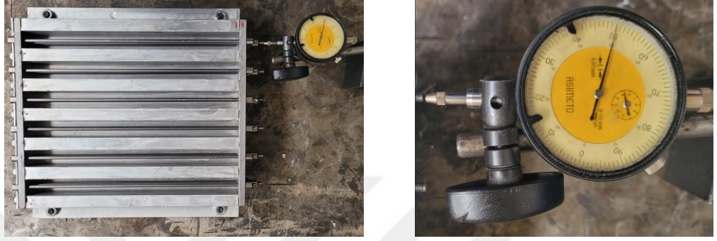
Şekil 3.13. Ön germe işleminin uygulanması
