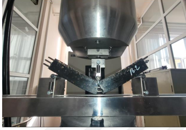
řekil 3.16. Ü nokta eęilme testinin yapılması
