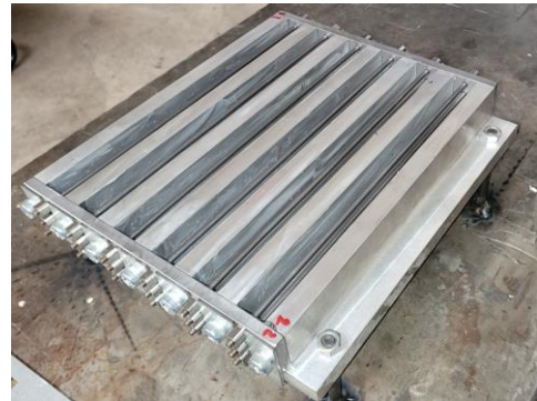
Şekil 3.4. Küp ve kiriş numunelerin hazırlanması için imal edilen kalıplar
