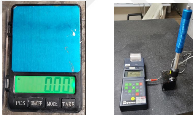
Şekil 3.6. Hassas terazi ve portatif sertlik ölçüm cihazı
