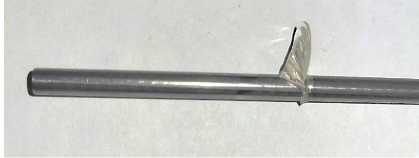
Şekil 4.3. Sıyrılma test numunesi yapışma yüzeyi
