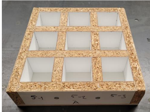
Şekil 3.4. Küp ve kiriş numunelerin hazırlanması için imal edilen kalıplar
