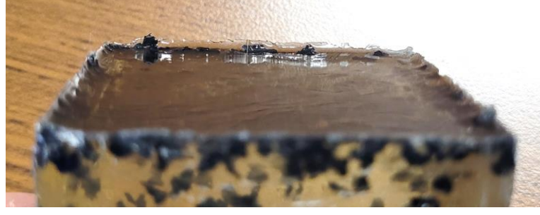
Şekil 4.6. Numunelerin üst yüzeyinde oluşan hacim büzülmesi (çöküntü)
