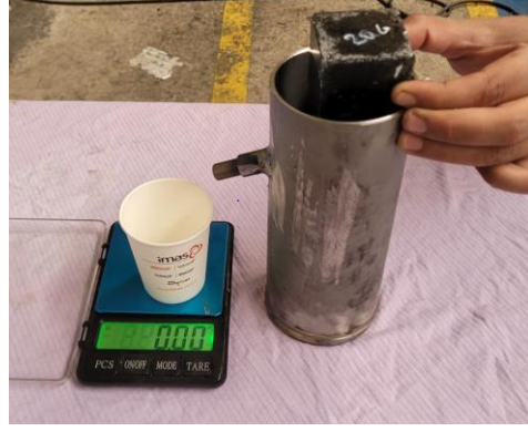
Şekil 3.11. Hazırlanan numunelerin hacim ölçümü
