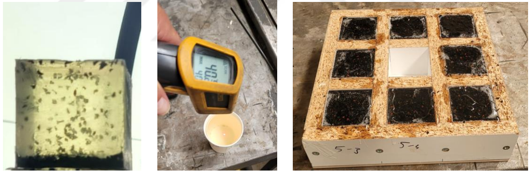
Şekil 3.10. Hazırlanan karışımın kalıba dökülmesi
