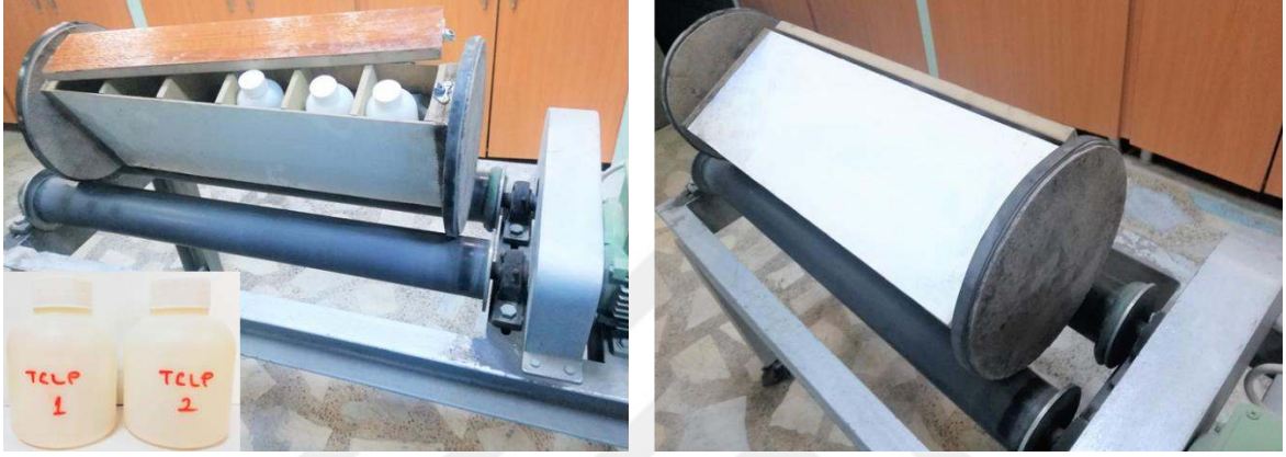
Şekil 2.5. Polipropilen kapaklı şişelerin hazırlanan düzeneğe yerleştirilmiş hali (solda) ve düzeneğin kapalı durumda karıştırma işlemi sırasındaki hali (sağda)
