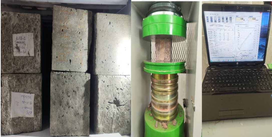
Şekil Ek 1.9. Donma-Çözünme deneyine ait bir görüntü
