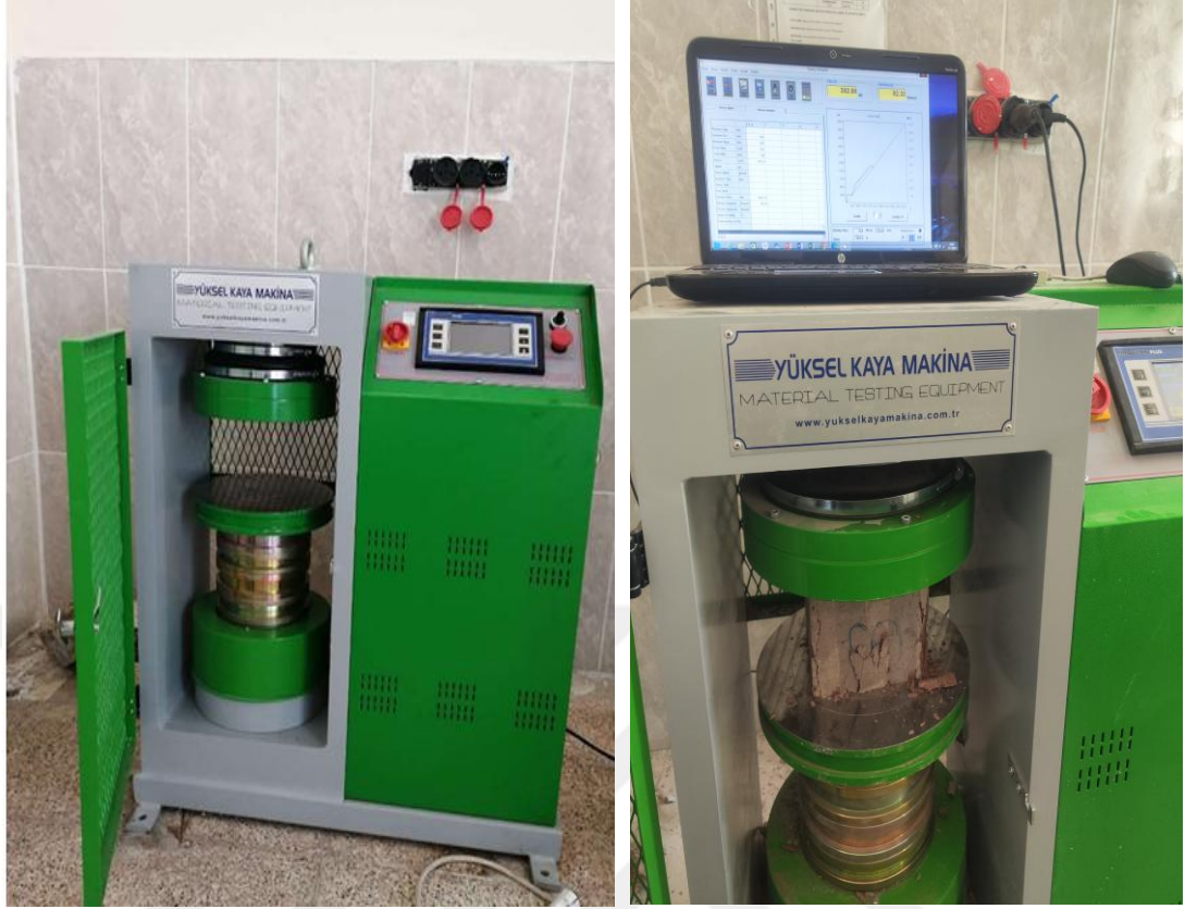
Şekil 3.6. Beton Basınç makinesi ve uygulanması
