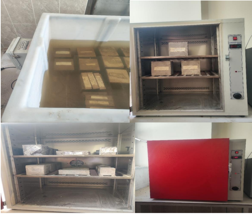
Şekil Ek 1.4. Numunelerin suda ve etüvde olan görüntüleri
