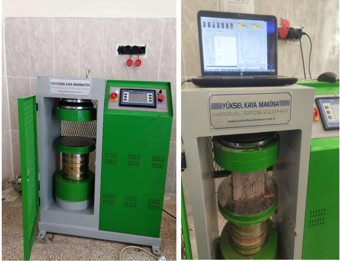
Şekil 3.6. Beton Basınç makinesi ve uygulanması
