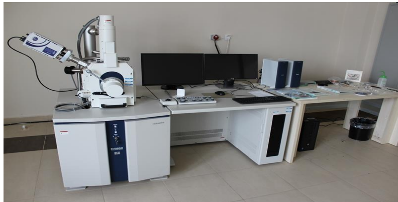
Şekil 3.13. SEM-EDX deney cihazı
