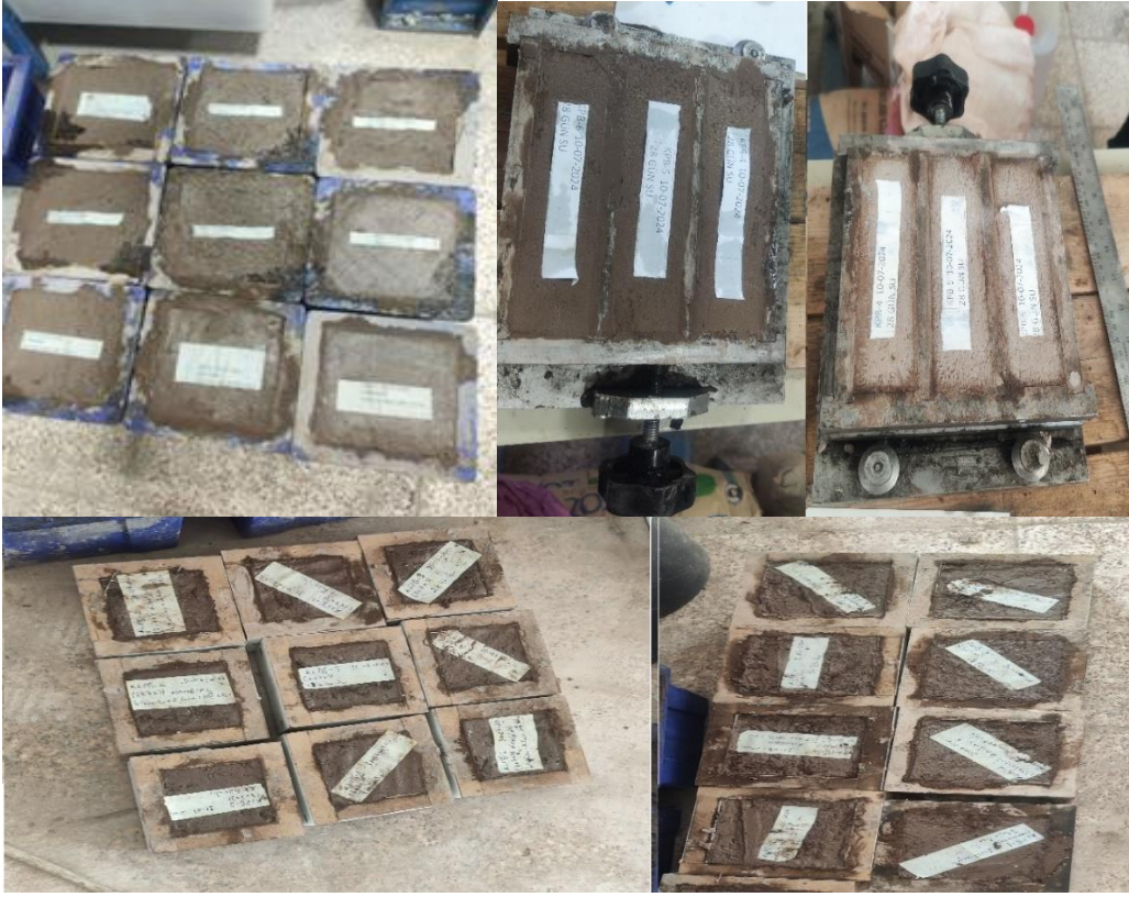
Şekil Ek 1.3. Numunelerin kalıplara konulması
