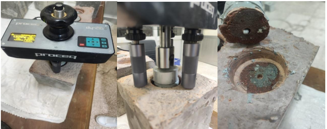
Şekil Ek 1.10. Yapışma deneyine ait bir görüntü
