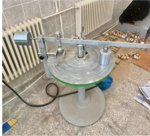
Şekil 3.8. Aşınma (Böhme) deneyi görünümü
