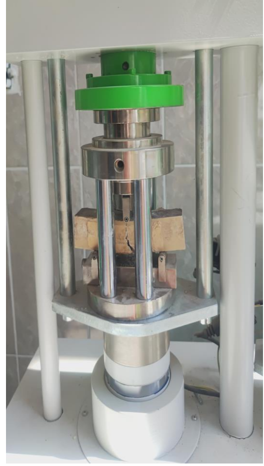
Şekil 3.7. Eğilme deneyine ait görüntü
