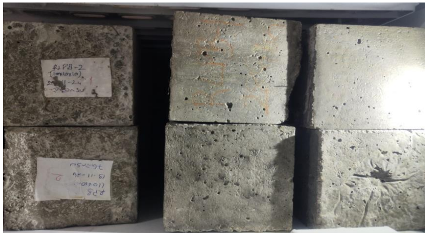
Şekil 3.9. Donma-çözünme deneyinin yapılışı
