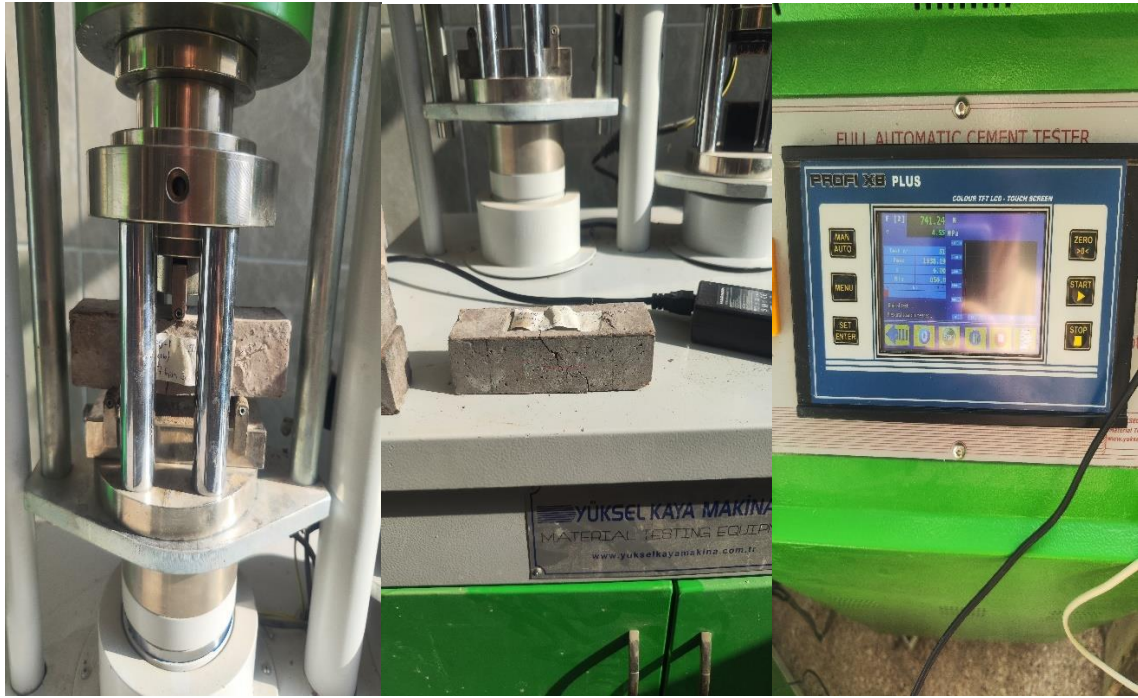
Şekil Ek 1.7. Eğilme deneyine ait bir görüntü
