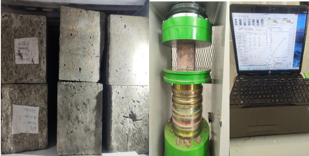
Şekil Ek 1.9. Donma-Çözünme deneyine ait bir görüntü
