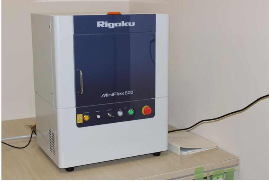
Şekil 3.15. XRD deney cihazı
