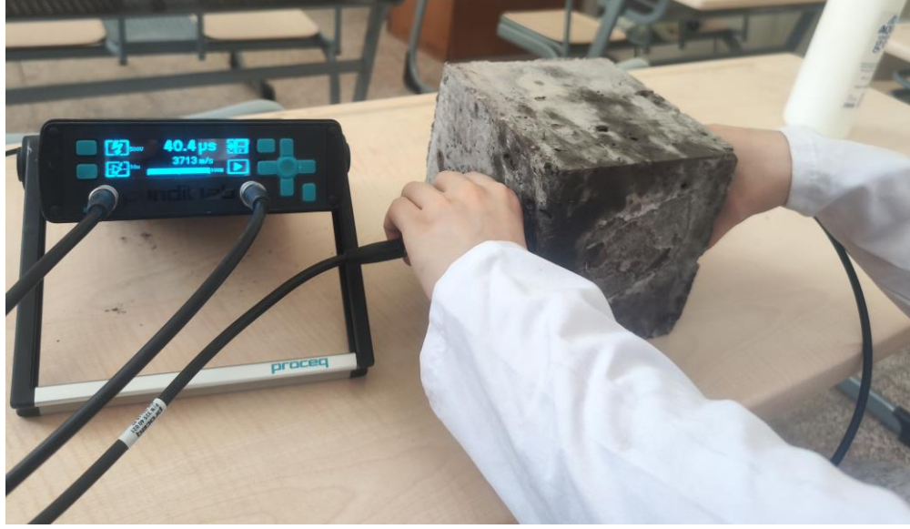
Şekil 3.11. UPV (Ultrasonik Ses Hızı) ölçüm örneği
