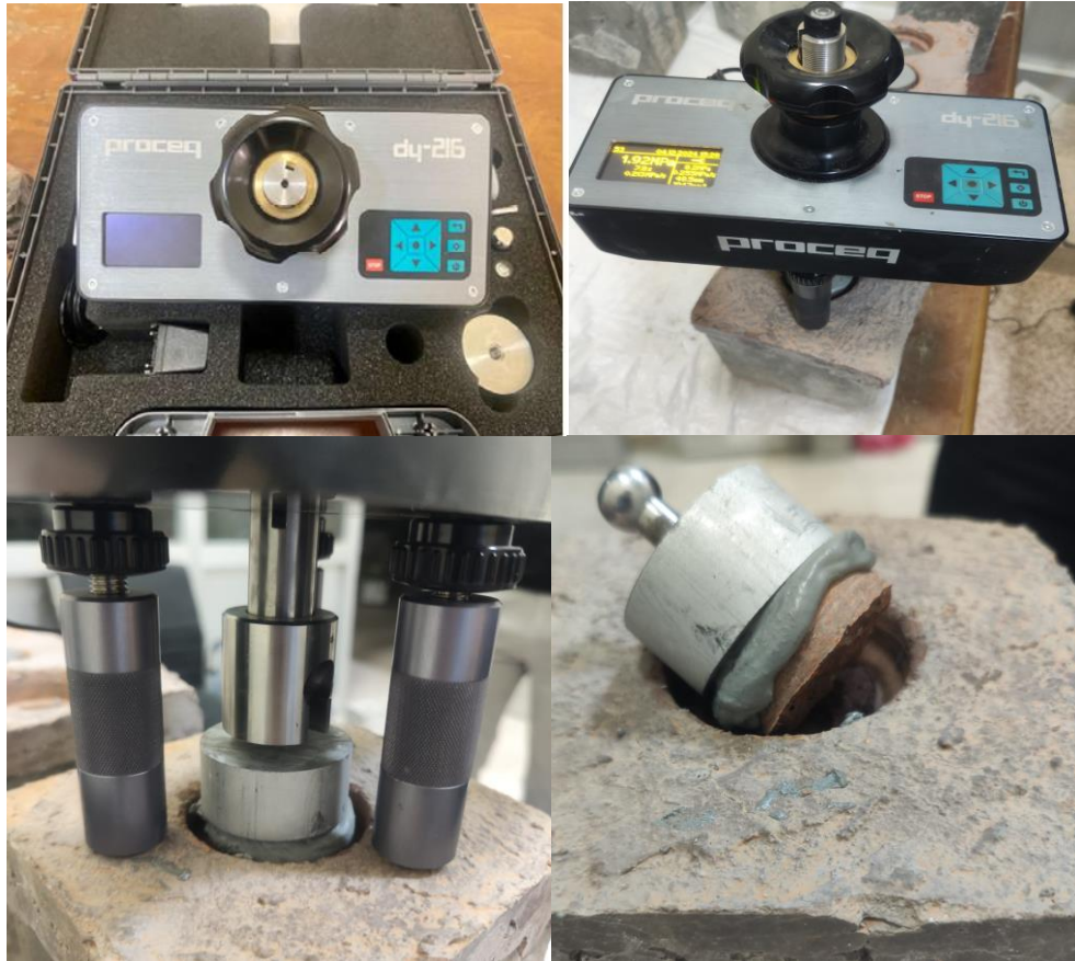
Şekil 3.12. Yapışma deneyi aleti ve yapışma deneyine ait örnek
