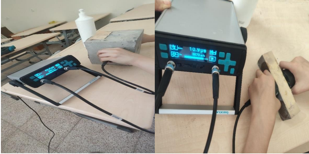
Şekil Ek 1.5. UPV deneyine ait görüntü
